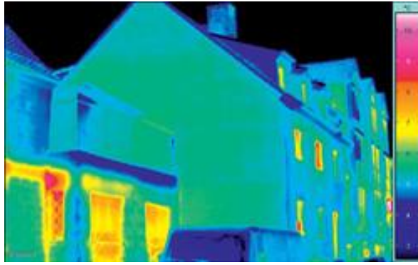
Εικ. 4.3 Θερμικές απώλειες με εξωτερική θερμομόνωση
