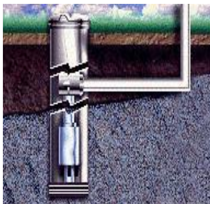
Εικ. 3.19 Αντλία νερού- πηγαδιού
