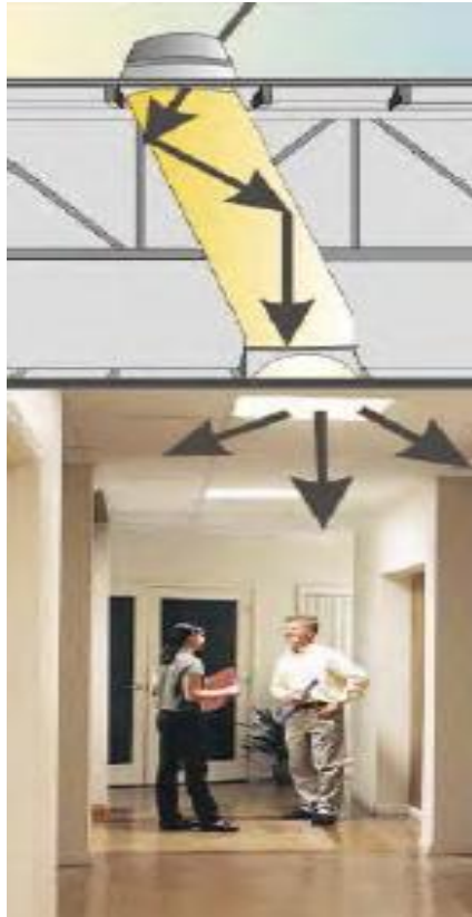
Εικ. 4.5 Αρχή λειτουργίας φωτισωλήνα
