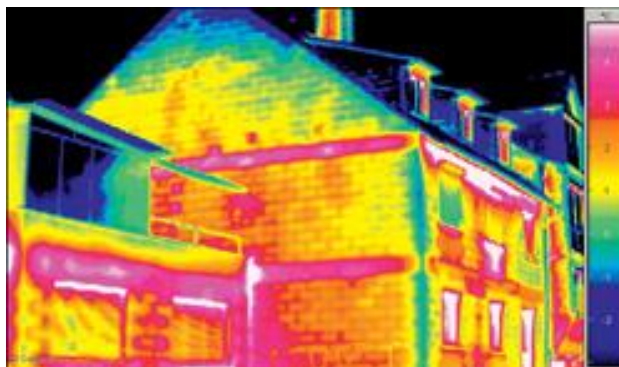
Εικ. 4.2 Θερμικές απώλειες χωρίς εξωτερική θερμομόνωση
