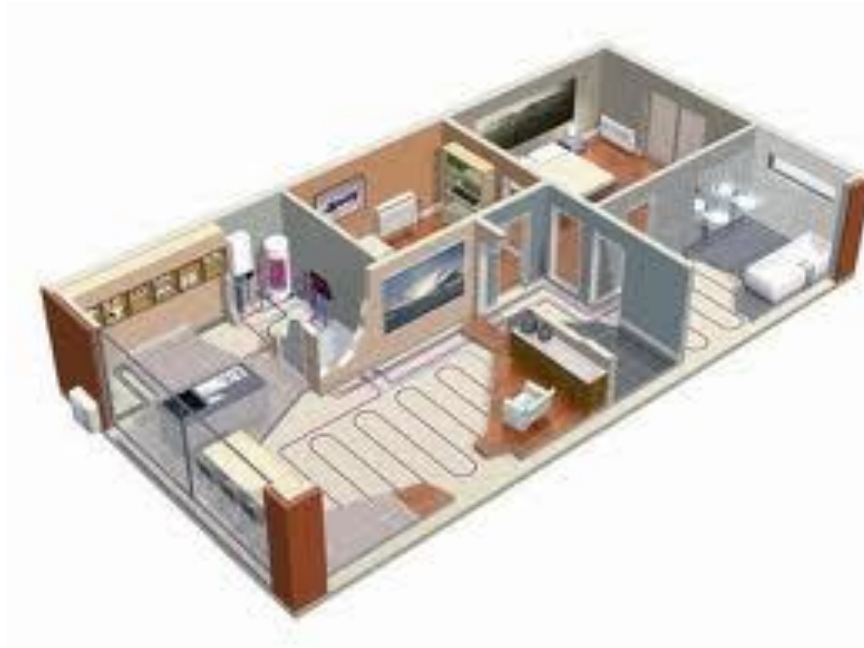
Εικόνα 1.5: Ενδοδαπέδια Θέρμανση Οικιακής Χρήσης
