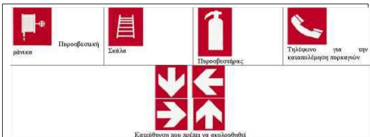
Εικόνα 2.1 (Σήμανση πυροσβεστικού εξοπλισμού)
