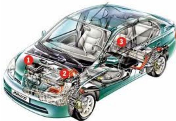
Εικόνα 5.7 - Toyota Prius (2001) : (1) Μηχανή , (2) Μετατροπέας , (3) Μπαταρία υψηλής τάσης .
