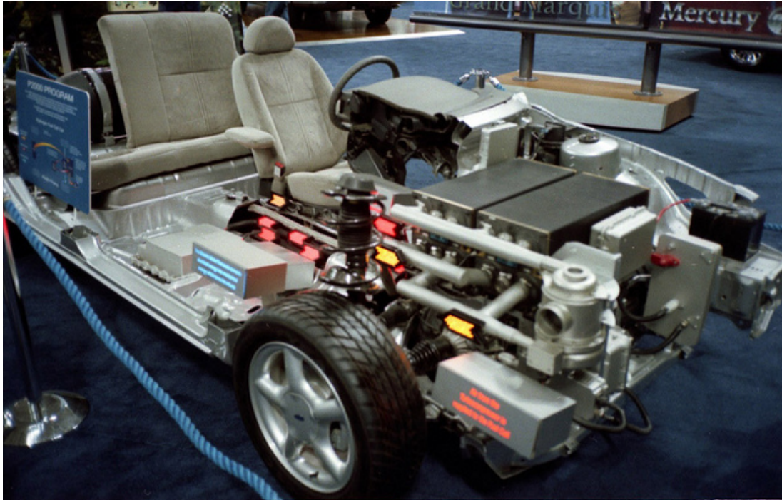
Εικόνα 5.5 - Σύστημα κυψελών καυσίμου οχήματος FORD P2000 Prodigy
