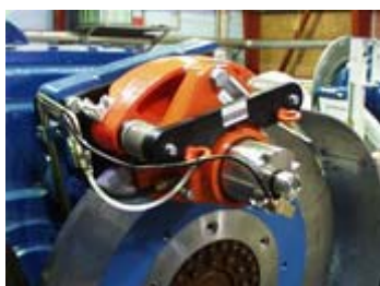
© 1998 www.WINDPOWER.org Εικόνα 4.5 Άποψη από μηχανική πέδη
