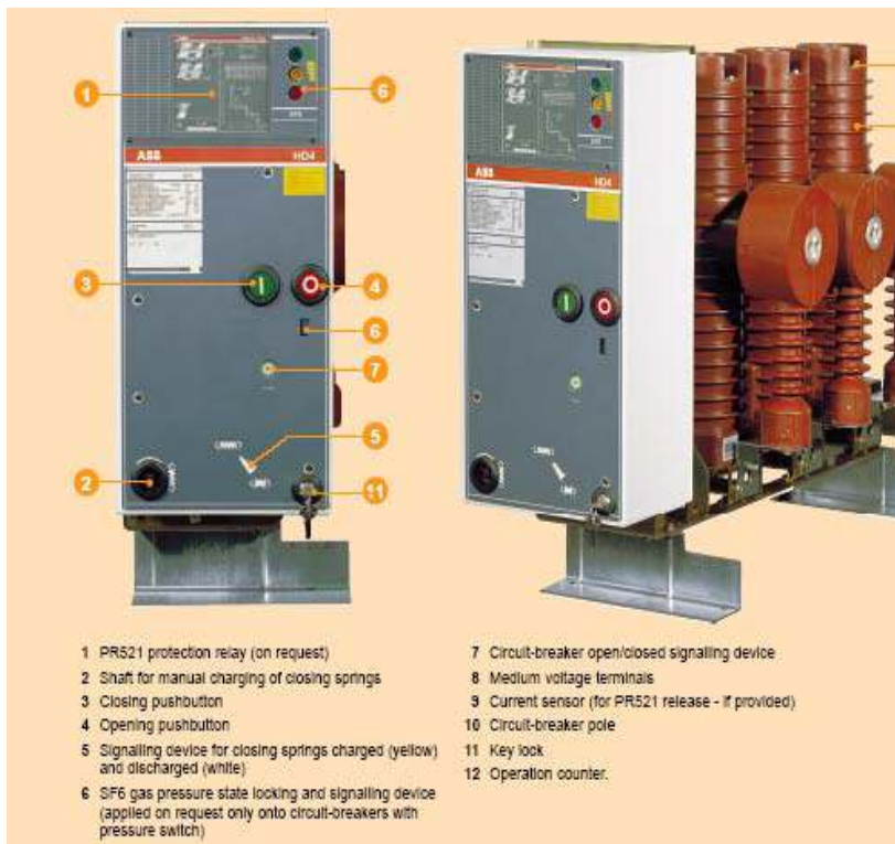
Σχήμα 4.24: Περιγραφή των βασικών στοιχείων ενός ΔΙ με SF 6
