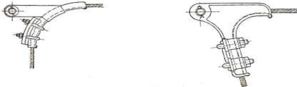
Σχήμα 2.24: Τρόπος δεσίματος των αγωγών στα τέρματα των γραμμών
