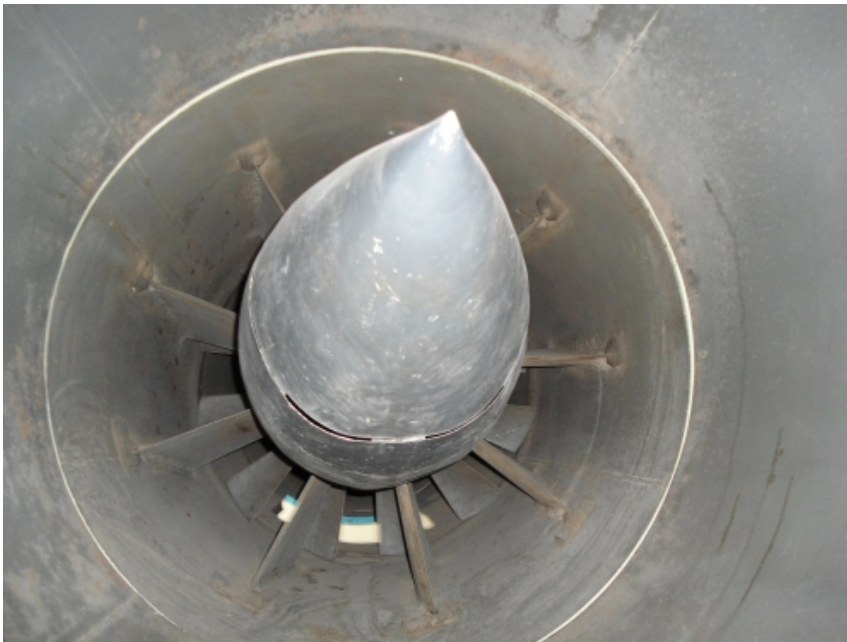
Εικόνα 3.2 Φωτογραφία από το εσωτερικό της αεροσήραγγας κλειστού τύπου.
