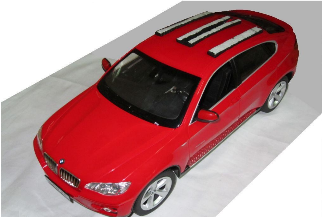
Σχήμα 4.17 Απεικόνιση της βάσης πάνω στην οροφή του RC μοντέλου.
