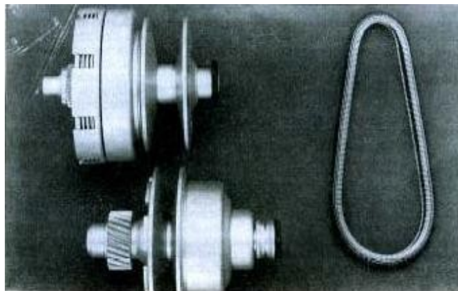
Σχήμα 2.11 Η δημιουργία της απαιτούμενης τριβής μεταξύ του ιμάντα και των τροχαλιών γίνεται με τη συμπίεση των πλαϊνών των μεταλλικών στοιχείων από τις παρειές της τροχαλίας.
