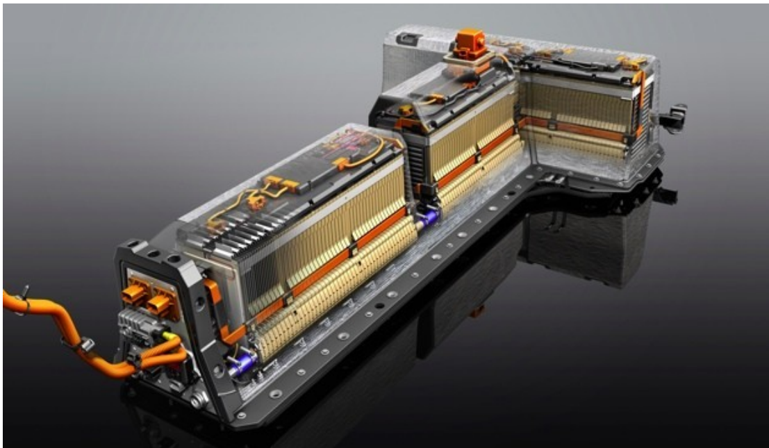
Σχήμα 2.12 Απεικόνιση της μπαταρίας των 16kWh του Chevrolet Volt. Η συστοιχία αποτελείται από 288 πρισματικές κυψέλες ιόντων λιθίου διάστασης 5x7 ίντσες έκαστη, το συνολικό της βάρος είναι 198,1 κιλά και φορτίζει πλήρως σε 4 ώρες σε οικιακή παροχή τάσης 240V.
