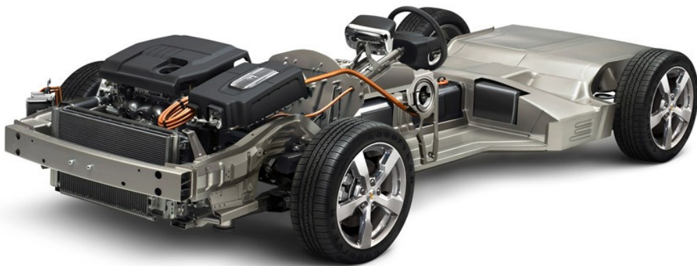
Σχήμα 3.3 Απεικόνιση της μονάδας κίνησης του Chevrolet Volt.
