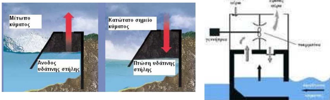
Σχήμα 1.4α : Σχηματική παράσταση συστήματος κίνησης ανεμογεννήτριας με συμπίεση του εσωτερικού αέρα στη διάταξη, με αξιοποίηση του κυματισμού.
