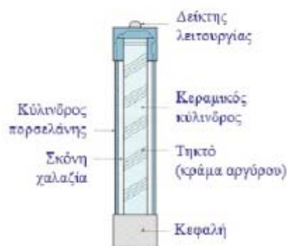
Εικόνα 2. 7 – βασικά μέρη μίας ασφάλειας σκόνης
