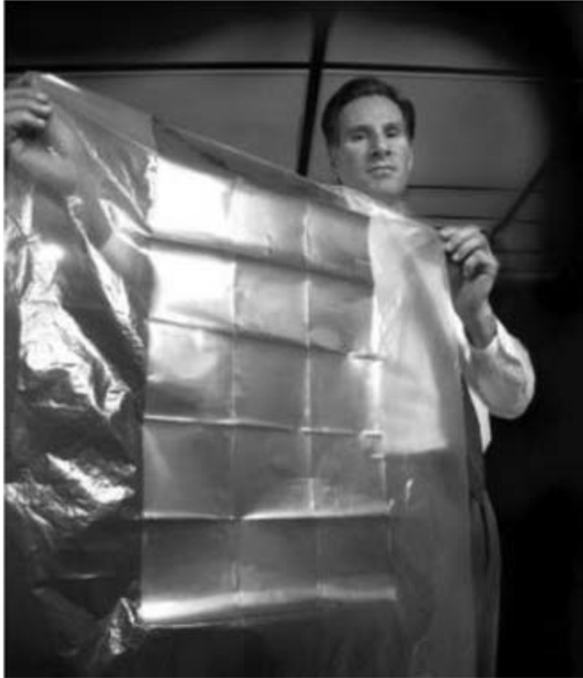
Σχήμα 5.21 Ερευνητής της ομάδας INL, Steven Novack, κρατά ένα πλαστικό φύλλο από συστοιχίες νανο-κεραιών, που δημιουργήθηκε με την εναπόθεση αγωγίμου μετάλλου στην ανάγλυφη δομή της κεραία που είχε δημιουργηθεί (Φωτογραφία Idaho National Laboratory).
