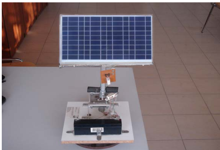
Φωτοβολταϊκό πάνελ τροφοδοσίας συστήματος (εικονα 44)
