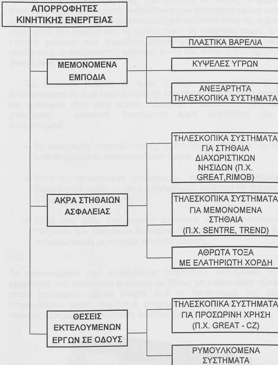
ΕΙΚΟΝΑ 3.1 : Συστήματα και πεδίο εφαρμογής απορροφητών κινητικής ενέργειας
