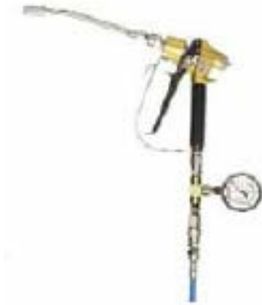
Εικ. 7.14: Μανόμετρο συσκευής ρητινένεσεων.
