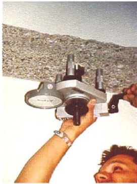
Εικόνα 1: Έλεγχος εφελκυστικής αντοχής υποστρώματος
