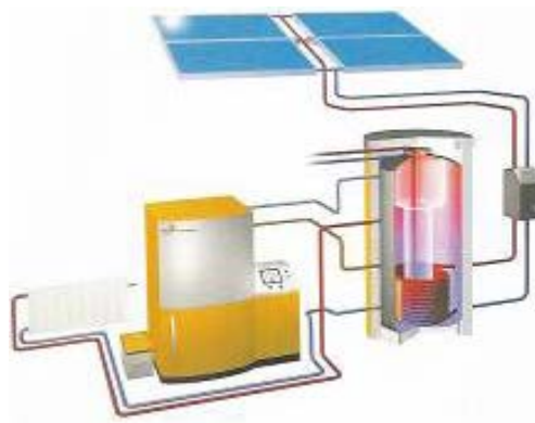
Υβριδικό σύστημα θέρμανσης με βιομάζα και ηλιακή ενέργεια
