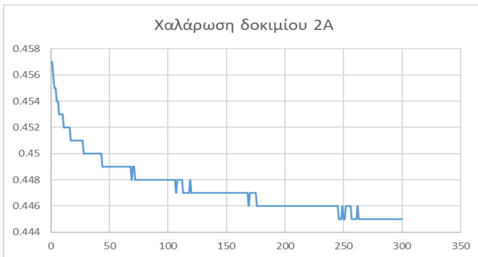
Σχ.17 Πρώτο σετ μετρήσεων της χαλάρωσης του Δοκιμίου 2 με βύθιση 1mm.
