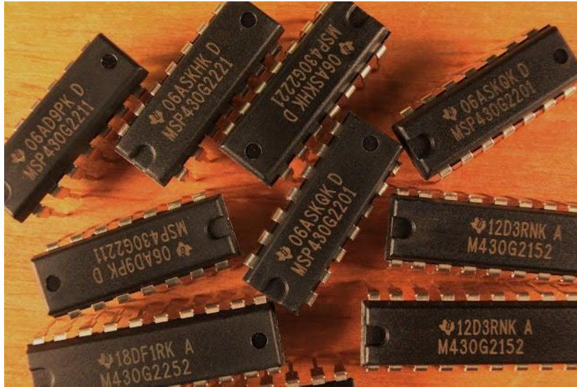
Εικόνα 12. Οικογένεια μικροελεγκτών MSP430G2xxx της Texas Instruments
