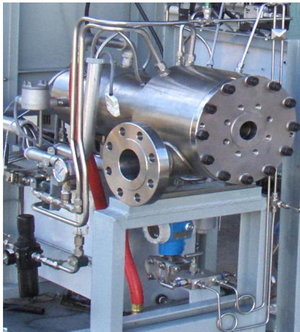
Σχήμα 2.6: Μαγνητική γεννήτρια υψηλής ταχύτητας 100kw.
