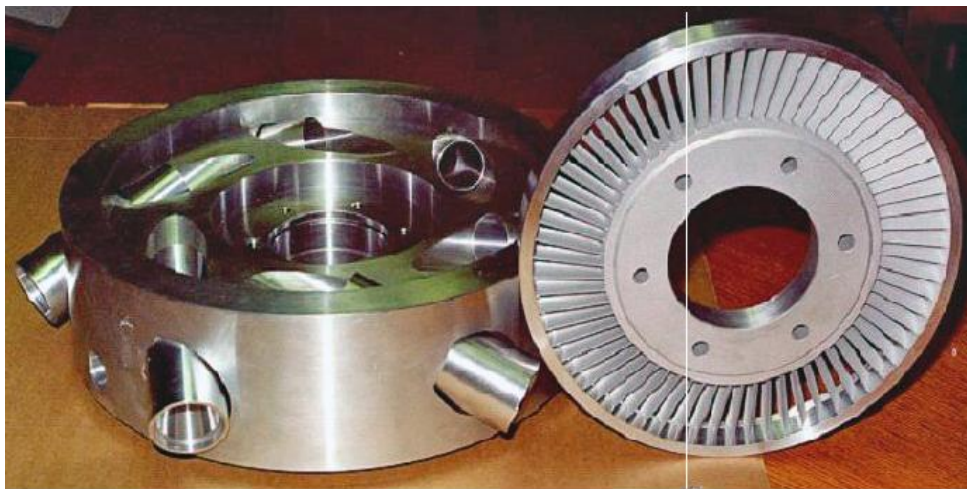
Σχήμα 2.12: Στρόβιλος μεταβλητής φάσης: κάλυμα με ακροφύσια και διφασικός παλμικός τροχός – ρότορας, αναλυτικά (συγκρότημα).
