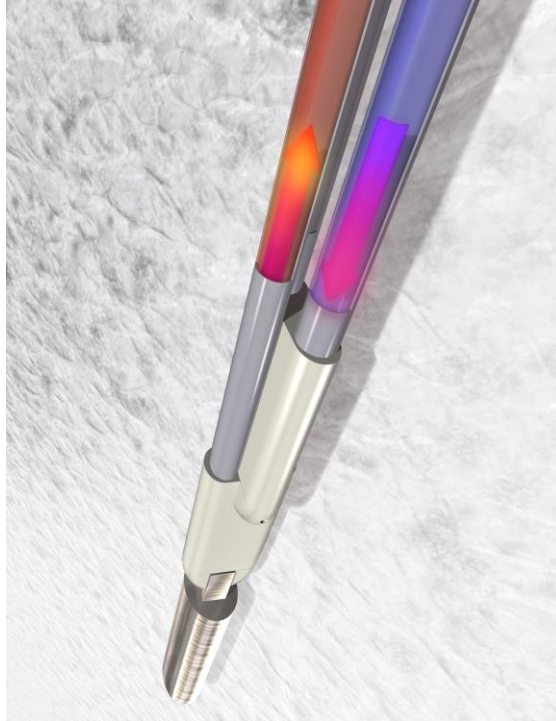
Σχήμα 1.2: Ανιχνευτής πηγής εδάφους- συνδυασμός σωληνώσεων γεωθερμικού εναλλάκτη πυθμένα, διπλού U(Βε) πολυαιθυλενίου σε σχήμα σταυρού μαζί με βαρίδιο στο κάτω μέρος
