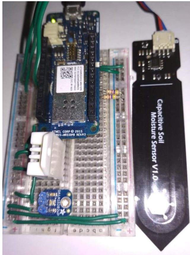
Εικόνα 20 Διακρίνουμε τα DHT22 (λευκό εξάρτημα), GAI11 (μπλέ αισθητήρας) και Moisture Sensor
