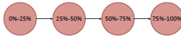
Σχήμα 7.2 Μηχανή κατάστασης για ένα εξάρτημα με ίσες κατανεμημένες καταστάσεις κατά τη διάρκεια του χρόνου. Τέτοιες μηχανές κατάστασης μπορούν να χρησιμοποιηθούν σε ένα σενάριο πρόβλεψης συντήρησης
