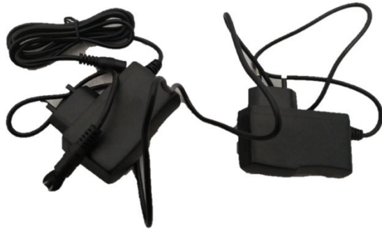
Εικόνα 5.4-2: α) Τροφοδοτικά εμπορίου input 220 V AC output 12V DC 2 A β) προσαρμογή τροφοδοτικού για την κατασκευή
