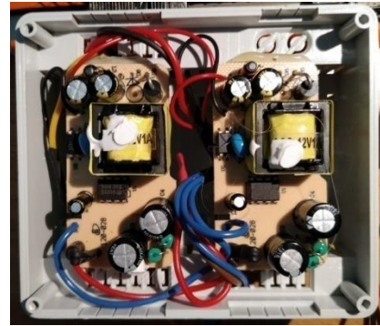
Εικόνα 5.4-2: α) Τροφοδοτικά εμπορίου input 220 V AC output 12V DC 2 A β) προσαρμογή τροφοδοτικού για την κατασκευή
