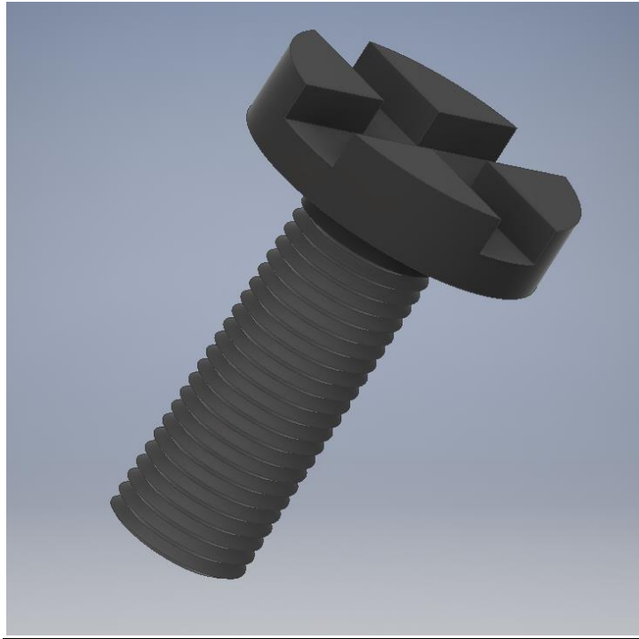
Εικόνα 2.20: Τρισδιάστατη όψη λαστιχένιας βάσης με σπείρωμα M30X3,5.
