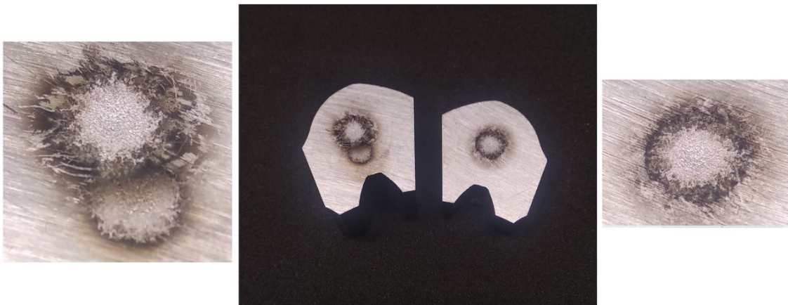
Εικόνα 6.19: Αποτυπώματα της φασματοσκοπίας AES στα δύο τμήματα του δοντιού Δ7.
