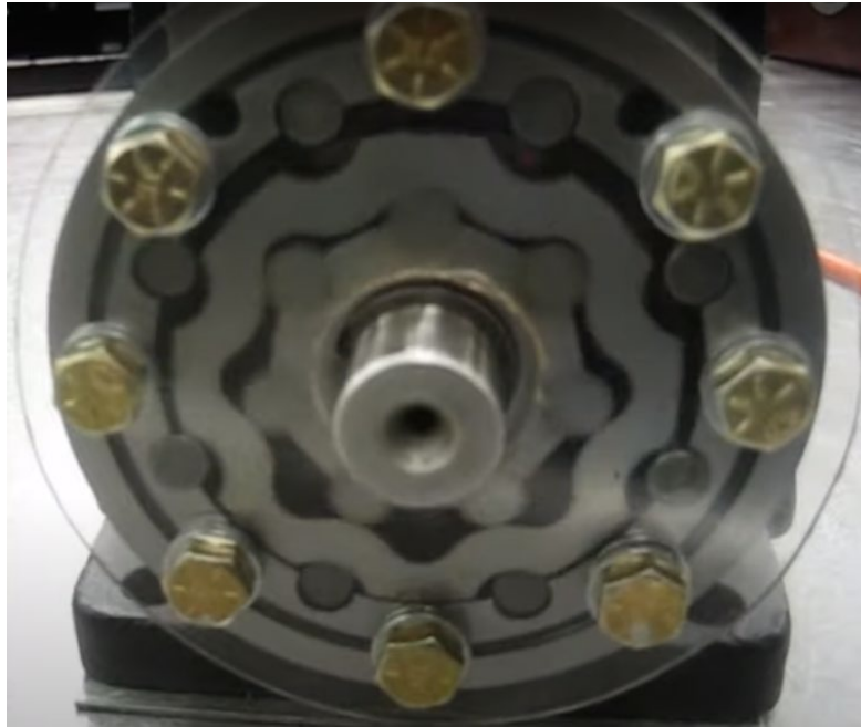
Εικόνα 3.23: Περιστροφικός κινητήρας εσωτερικής οδόντωσης με ενδιάμεσο οδοντωτό δαχτυλίδι και με προσαρτημένους κυλίνδρους [74].
