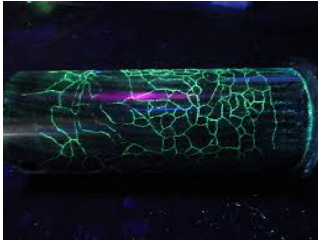
Εικόνα 1.29: Εντοπισμός ρωγμών με τη χρήση φθορίζοντων - διεισδυτικών υγρών [14].
