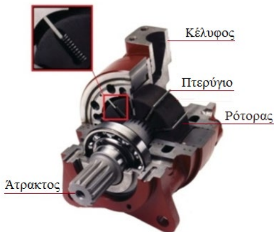
Εικόνα 3.6: Περιστροφικός υδραυλικός κινητήρας με πτερύγια, σε τομή. Χρήση ελατηρίων για το σπρώξιμο των πτερυγίων προς την εσωτερική επιφάνεια του κελύφους [56].
