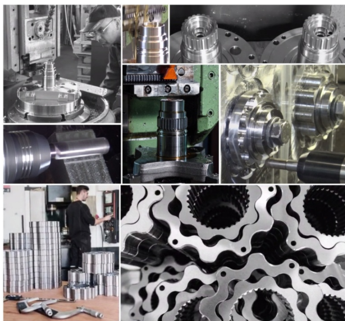
Εικόνα 4.1: Παρουσίαση της μηχανουργικής κατεργασίας των κύριων μερών ενός κινητήρα εσωτερικής οδόντωσης [65].
