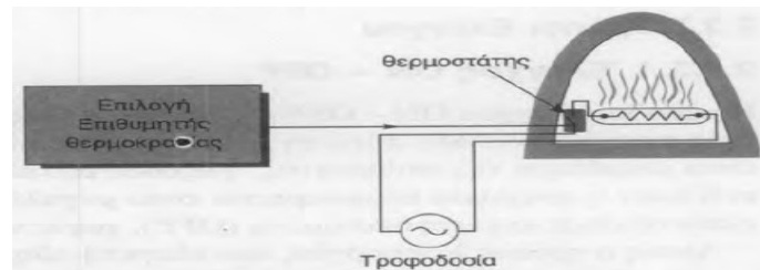
Εικόνα 4.15 Έλεγχος θερμοκρασίας με θερμοστάτη
