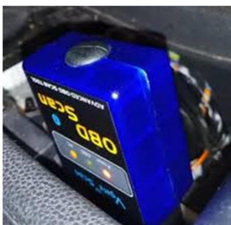
Εικόνα 21: Ο OBD2 adapter σε λειτουργία
