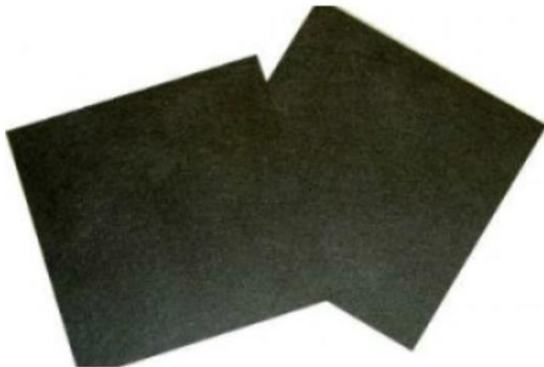
ΕΙΚΟΝΑ 2.8 ΧΑΡΤΙΝΑ ΗΛΕΚΤΡΟΔΙΑ ΜΑΥΡΟΥ ΛΕΥΚΟΧΡΥΣΟΥ – ΑΝΘΡΑΚΑ 2 mg/cm 2 [6]
