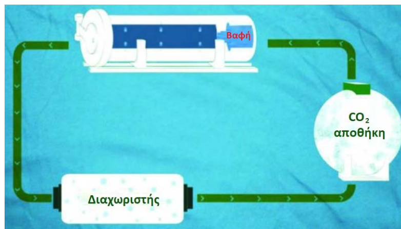
Σχήμα 6.28 Τεχνολογικό διάγραμμα βαφής με χρήση υπερκρίσιμου CO 2
