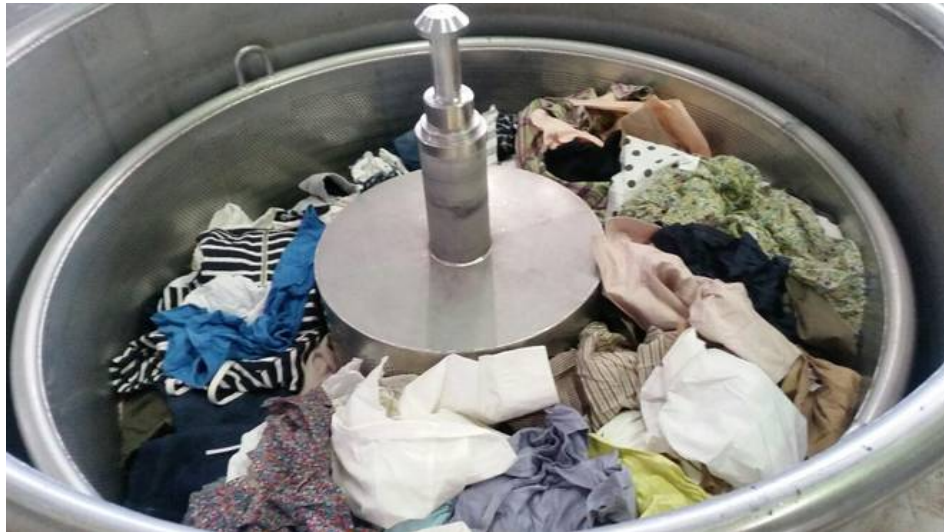
Εικόνα 21 Δεξαμενή για την εξαγωγή αιθανόλης από βαμβακερά ρούχα
