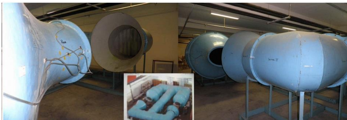
Εικόνα 7: Αεροσήραγγα κλειστού κυκλώματος ροής του εργαστηρίου.
