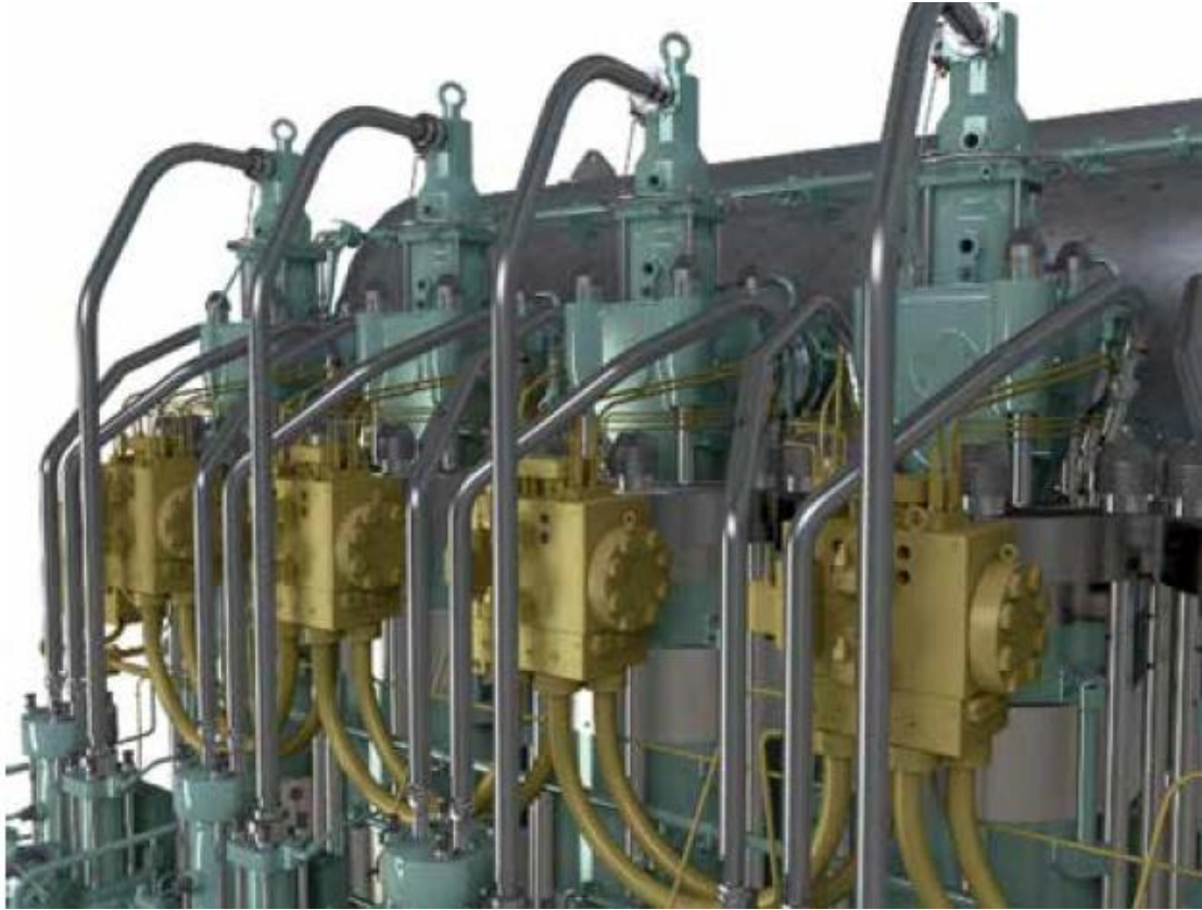
Σχήμα 4.23: Η νέα & επιπρόσθετη μονάδα αερίου της μηχανής ME-GI [20].
