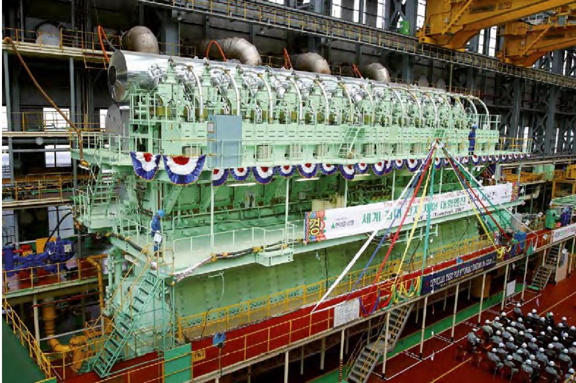
Σχήμα 1.4: Ο ισχυρότερος ναυτικός κινητήρας Diesel με ισχύ 84.420kW, ο 14κύλινδρος, δίχρονος και αργόστροφος Wärtsilä RT-flex96C (Hyundai Heavy Industries) [4].
