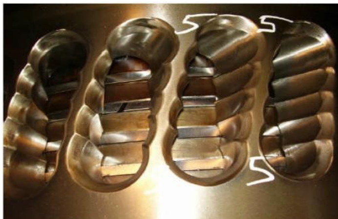
Σχήμα 2.9: Χιτώνιο μεγάλης αργόστροφης μηχανής με τις θυρίδες εισαγωγής και εσωτερικά τα ελατήρια του εμβόλου [8].
