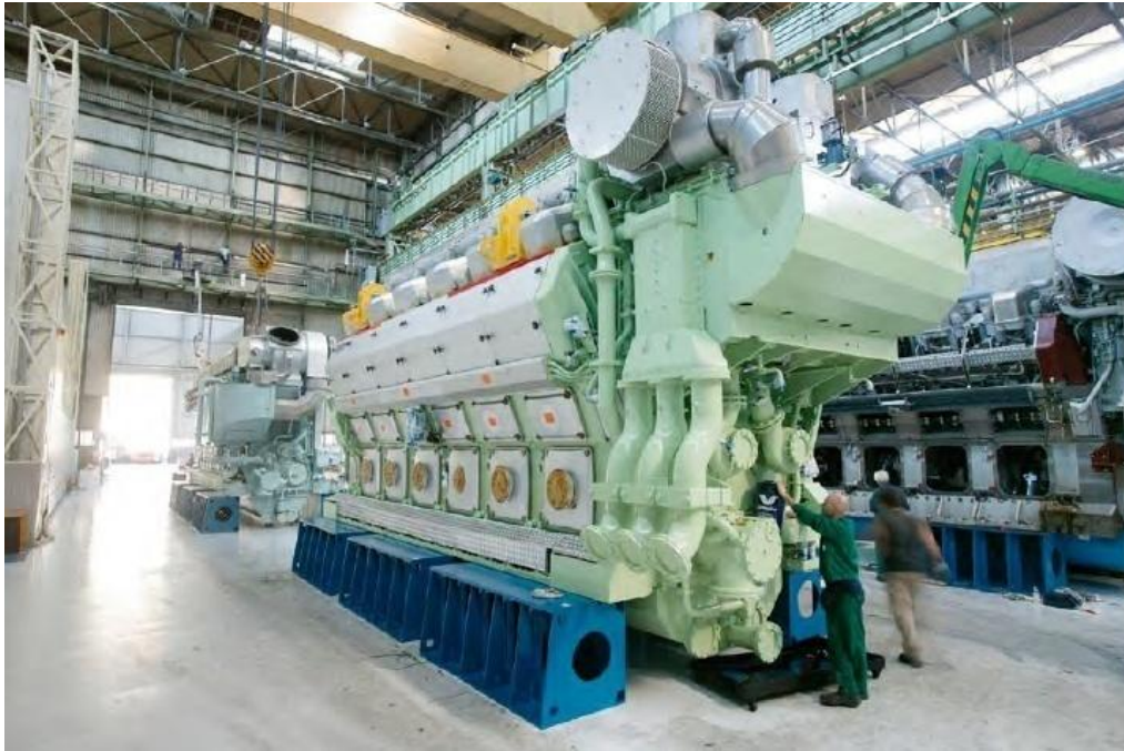
Σχήμα 4.12: Μηχανή 50DF V12 της εταιρίας Wärtsilä για πρόωση LNG carrier [4].
