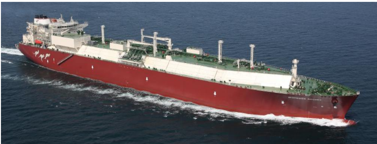
Σχήμα 3.3: Πλοίο μεταφοράς LNG με δεξαμενές τύπου μεμβράνης [17].
