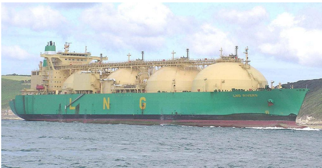
Σχήμα 3.1: Πλοίο μεταφοράς LNG με ανεξάρτητες δεξαμενές τύπου Moss [13].
