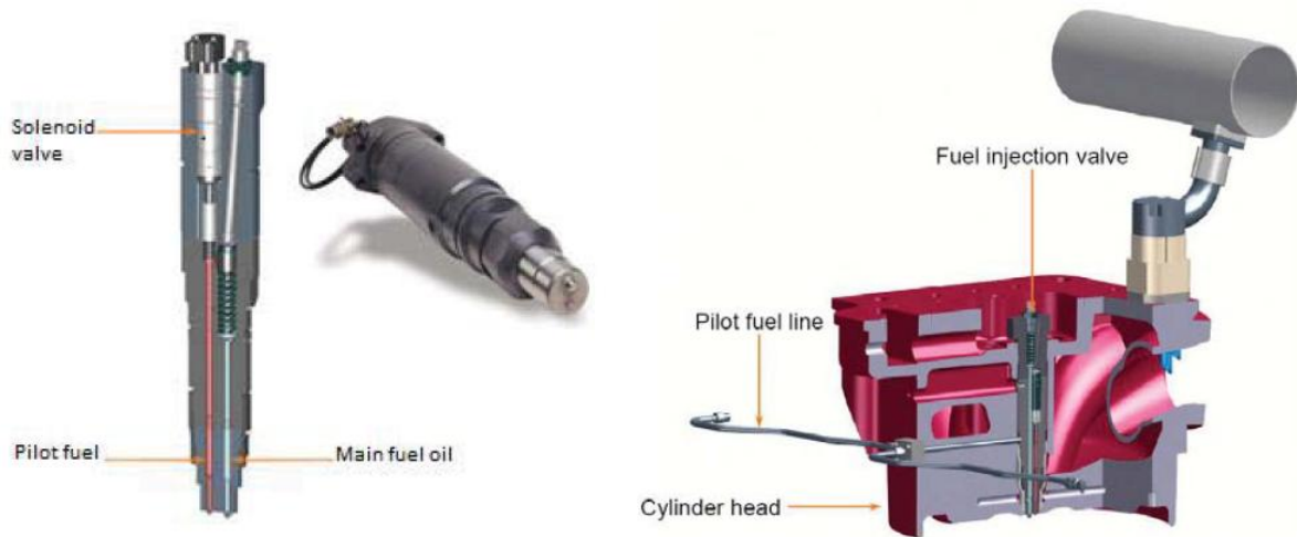
Σχήμα 4.11: Εγχυτήρας διπλού ακροφυσίου των μεσόστροφων μηχανών DF [23].
