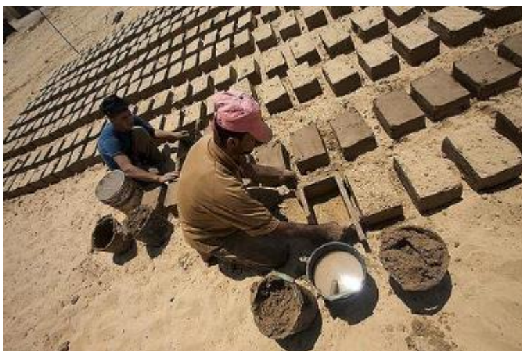
Εικόνα 5: Κατασκευή φυσικών συμπαγών πλίνθων
