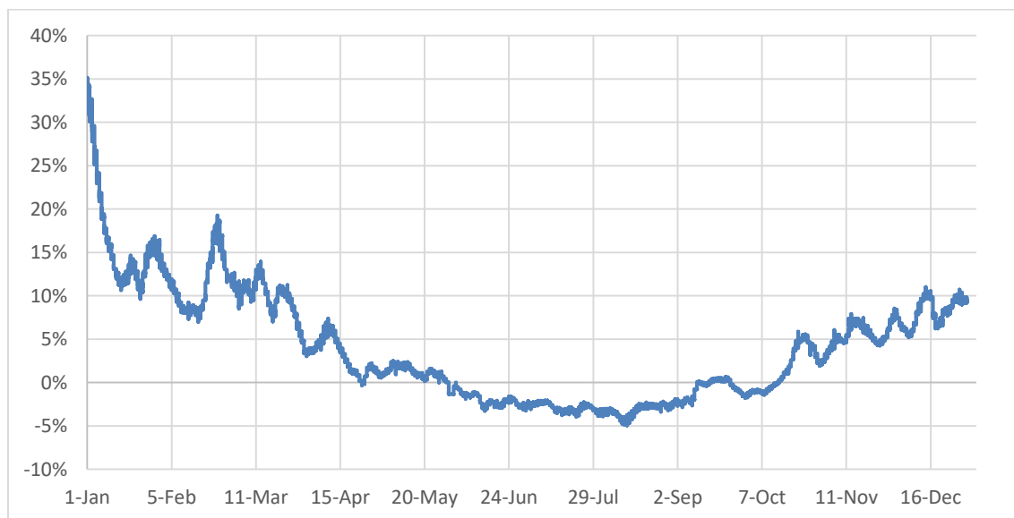
Εικόνα 39: Ποσοστιαία διαφορά θερμοκρασιών σε °C μεταξύ οπτοπλινθοδομής και ομωπλινθοδομής βήμα λήψης μετρήσεων ανά ώρα
