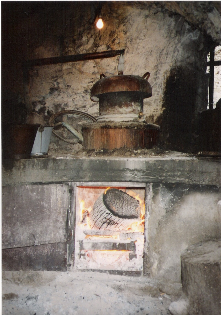
μηχανισμός παρασκευής σούμας-φούρνος (ανοιχτός)
