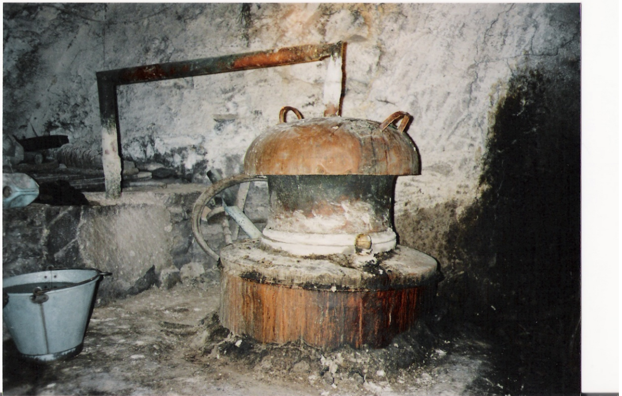
Μηχανισμός παρασκευής σούμας (τσιμπούκι-καζάνι)
