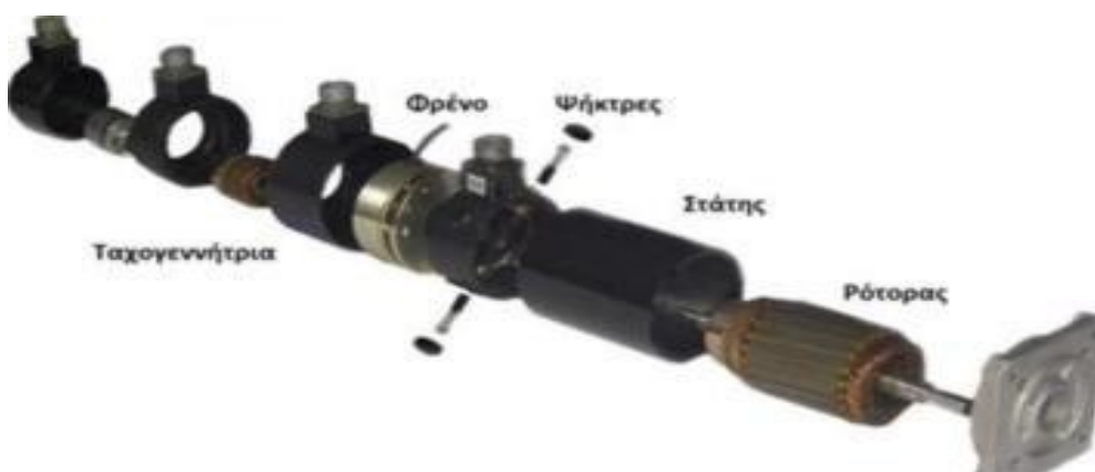
Εικόνα 4.3.1 Σερβοκινητήρας με σύστημα ψηφιακών-συλλέκτη και ενσωματωμένο κωδικοποιητή, ταχογεννήτρια και φρένο
