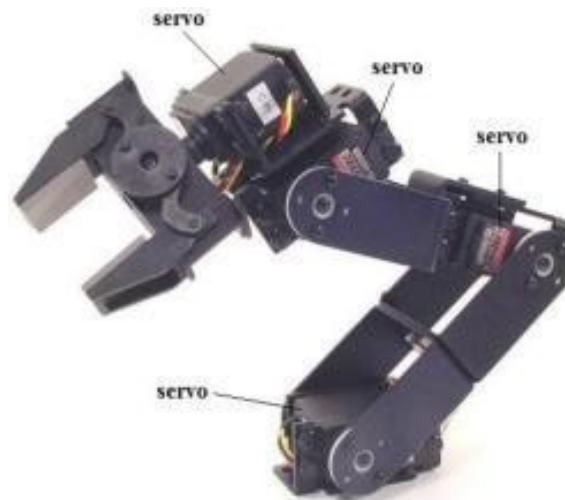
Εικόνα 4.8.1 Ρομποτικός βραχίονας τεσσάρων αξόνων με χρήση RC servo.
