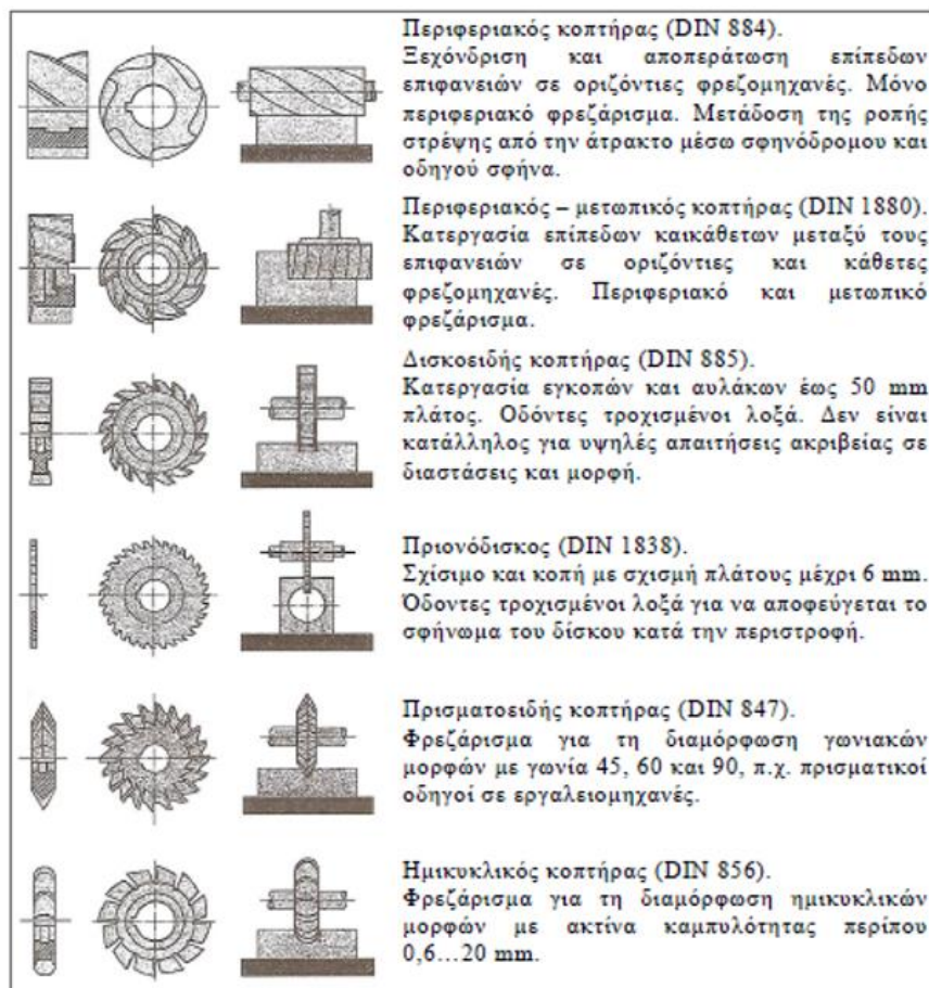
Εικόνα 1. 18-Τύποι Κοπτήρων κατά πρότυπα DIN.
