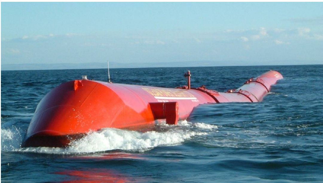
Εικόνα 28 Πλωτή εγκατάσταση εκμετάλλευσης κυματικής ενέργειας
