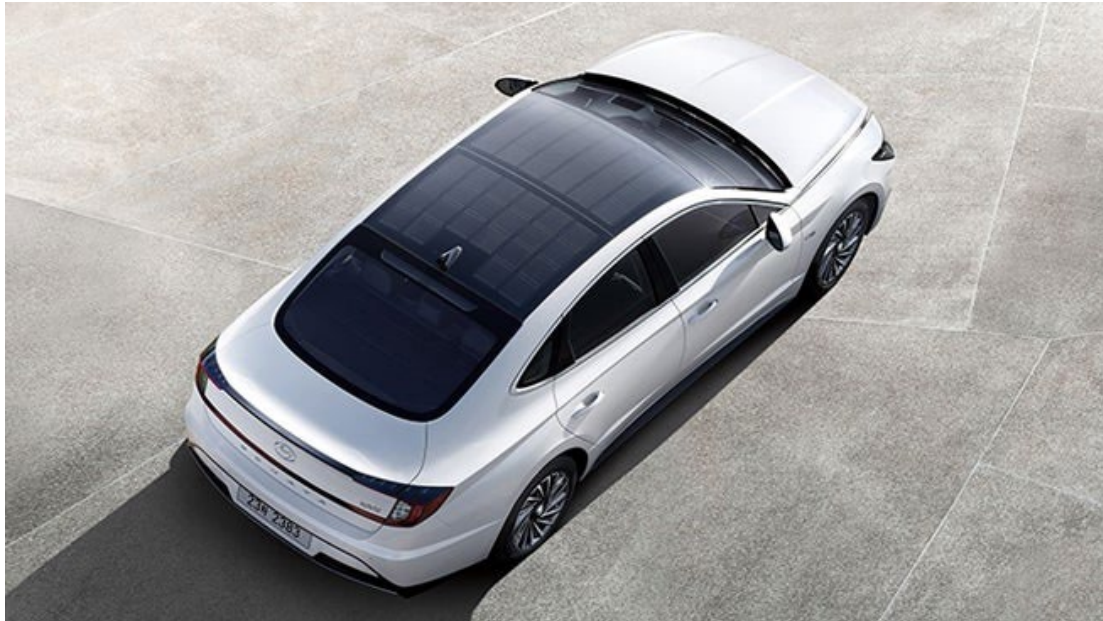
Εικόνα 20 Το μοντέλο Sonata Hybrid της εταιρείας Hyundai (2019) φέρει ηλιακά πάνελ στην οροφή του.
