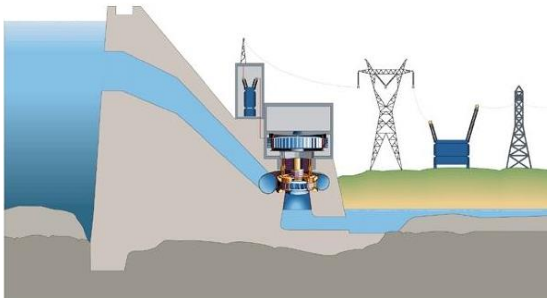
Εικόνα 10 Σχηματικό διάγραμμα τυπικού υδροηλεκτρικού εργοστασίου
