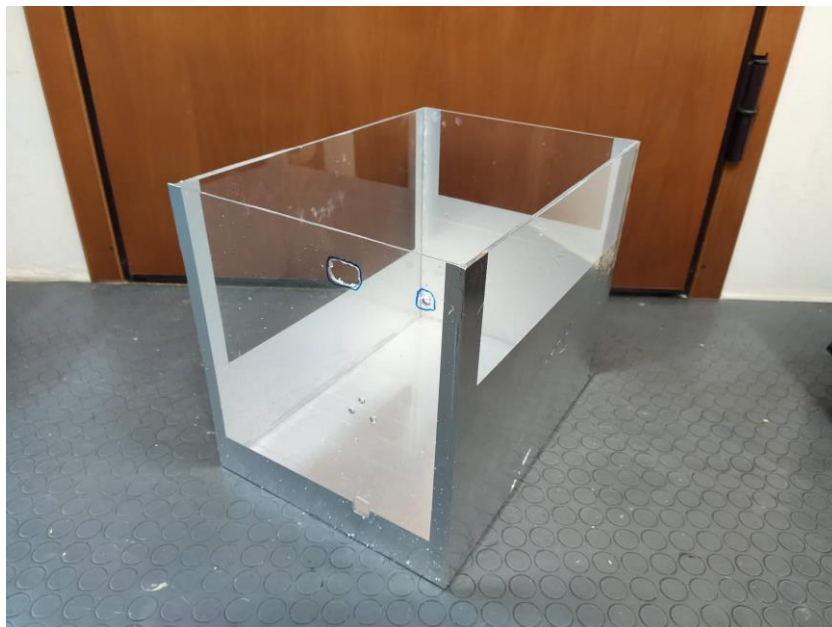
Εικόνα 4.12 : Κουτί θερμοδοχείου, σωληνώσεων και οργάνων
