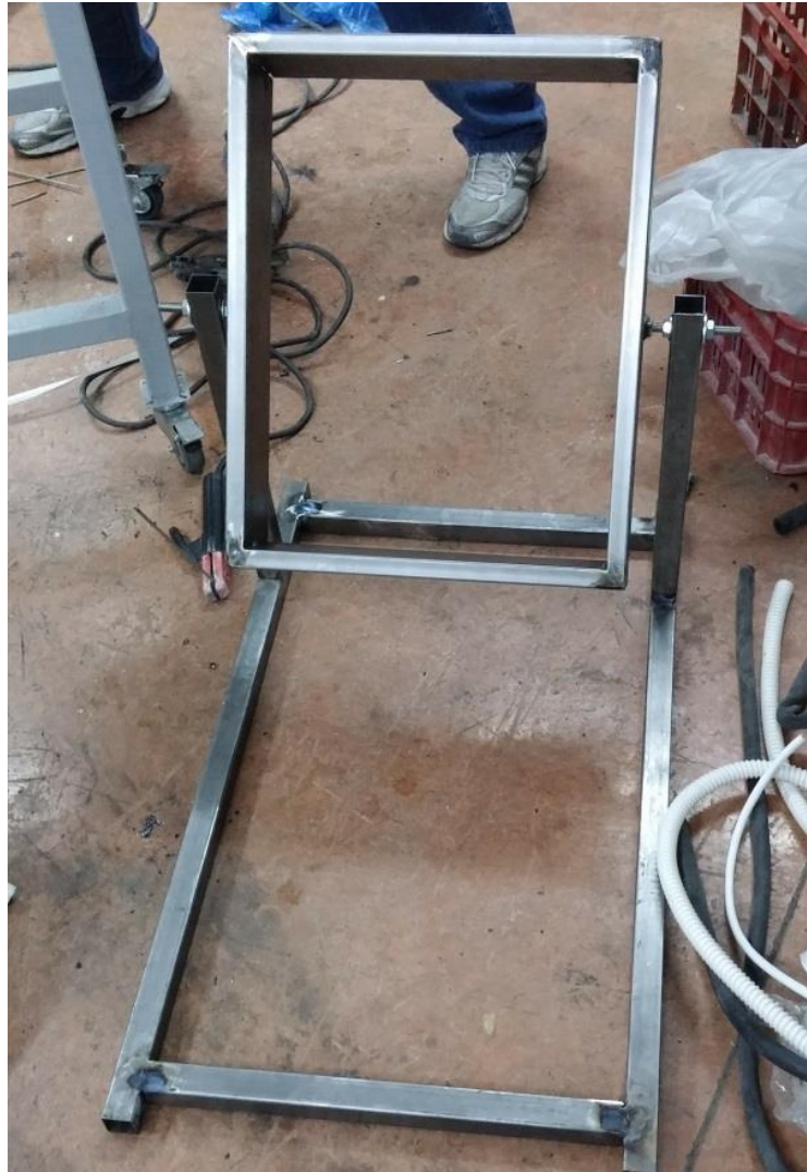
Εικόνα 4.3: Βάση συλλέκτη με το πλαίσιο του συλλέκτη
