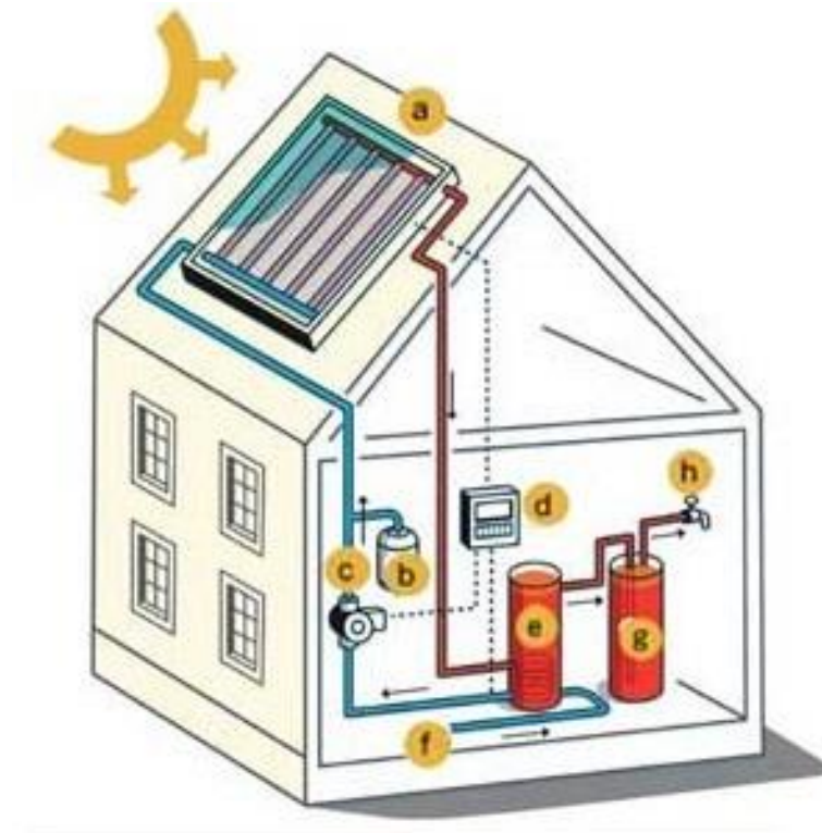
Εικόνα 1.13: Σύστημα εξαναγκασμένης ροής σε οικία [8]
