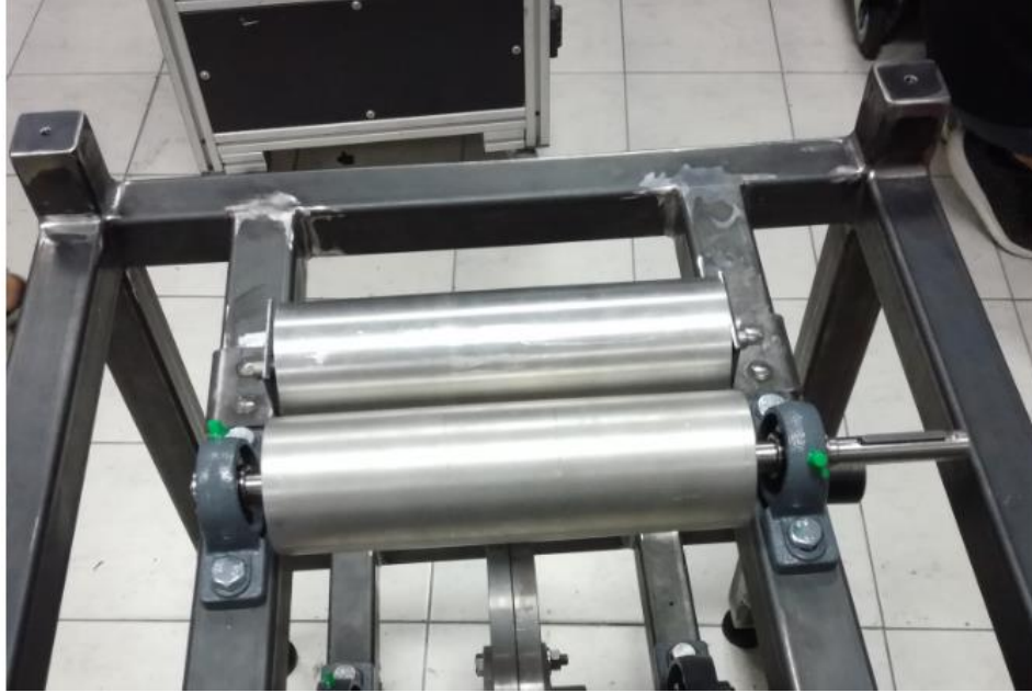
Εικόνα 132: Στήριξη εμπρόσθιου ράουλου (POS20_CD_FRONT DRUM_SUB ASSEMBLY).
