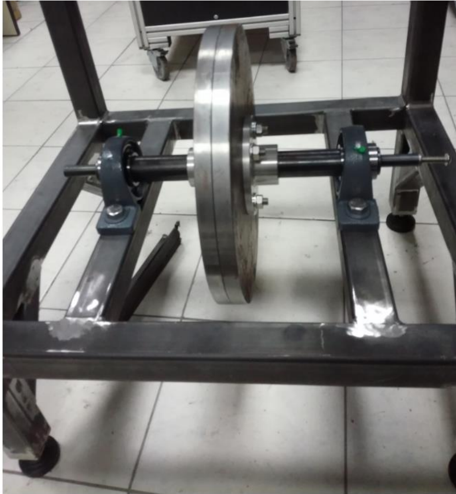
Εικόνα 128: Στήριξη άξονα αδρανειακής μάζας στο μεταλλικό πλαίσιο.
