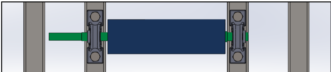
Εικόνα 40: Τελική σύνδεση Σασί – Εμπρόσθιου ράουλου. Κάτοψη.
