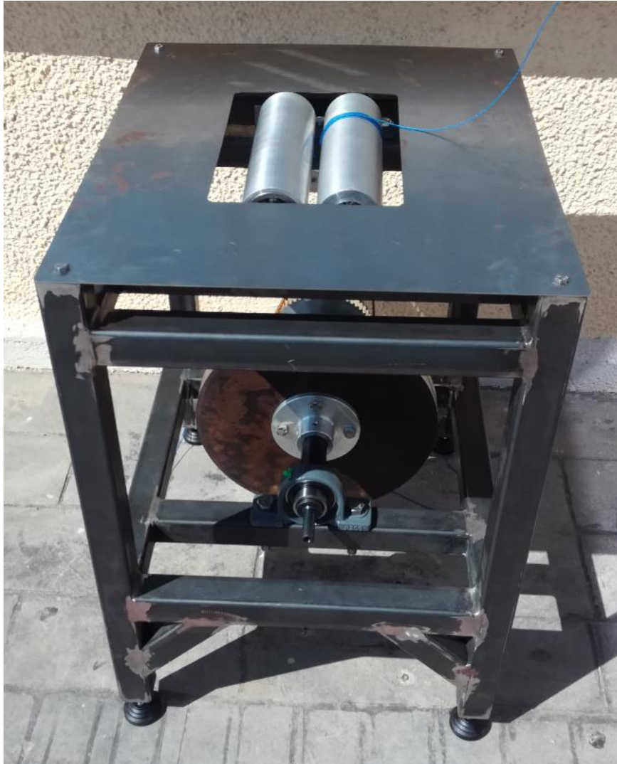
Εικόνα 152: Αδρανειακή δυναμοτράπεζα στον χώρο του πειράματος.
