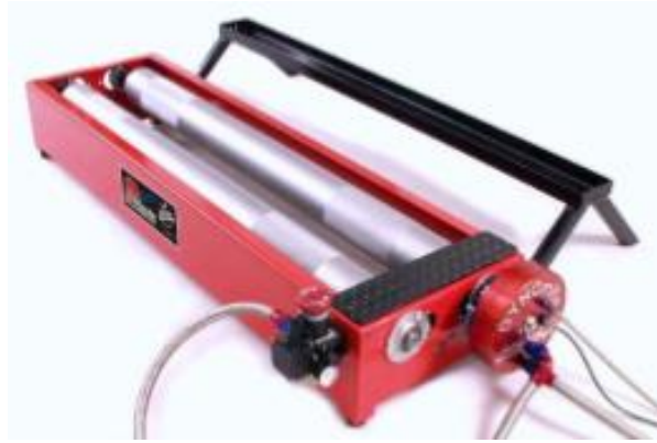
Εικόνα 7: Αδρανειακό δυναμόμετρο για δίκυκλα οχήματα και αγωνιστικά καρτ.
