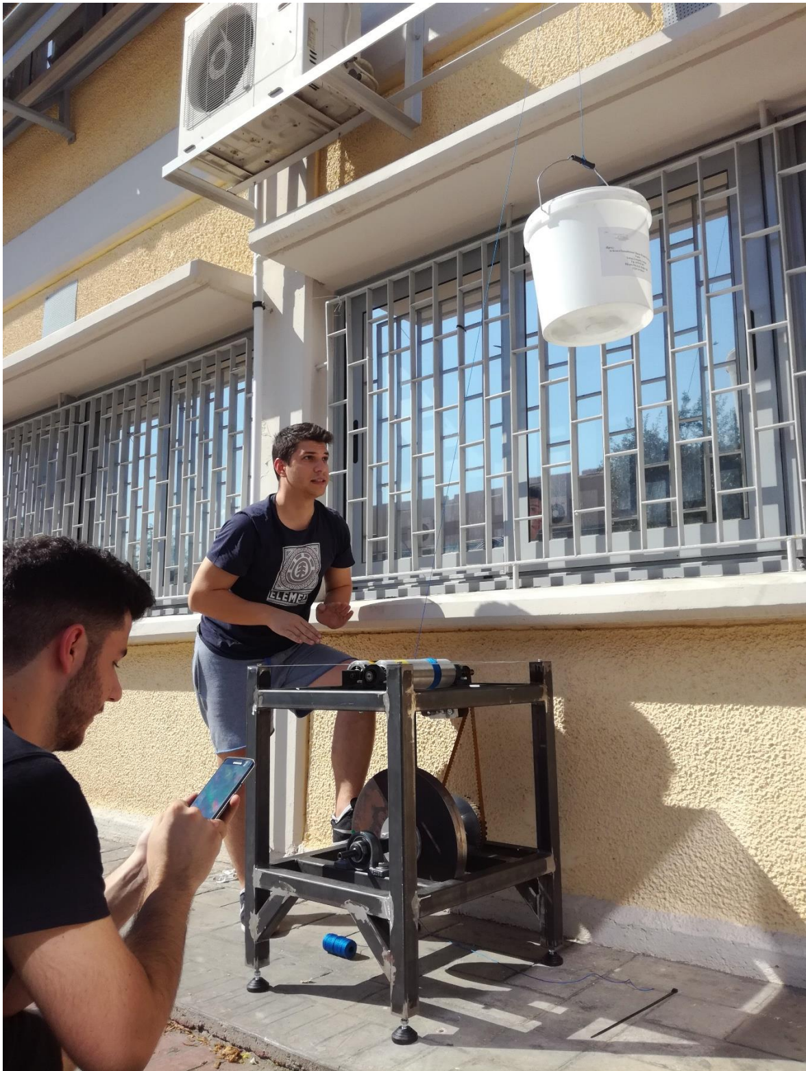
Εικόνα 157: Πτώση βάρους προς το έδαφος και καταγραφή χρόνου πτώσης.
