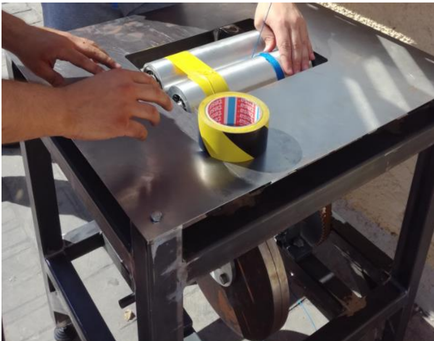
Εικόνα 153: Πρόσδεση εμπρόσθιου και βοηθητικού ράουλου.
