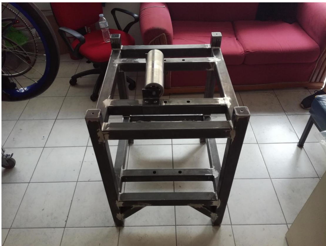
Εικόνα 114: Στήριξη βοηθητικού ράουλου στο σασί της διάταξης.
