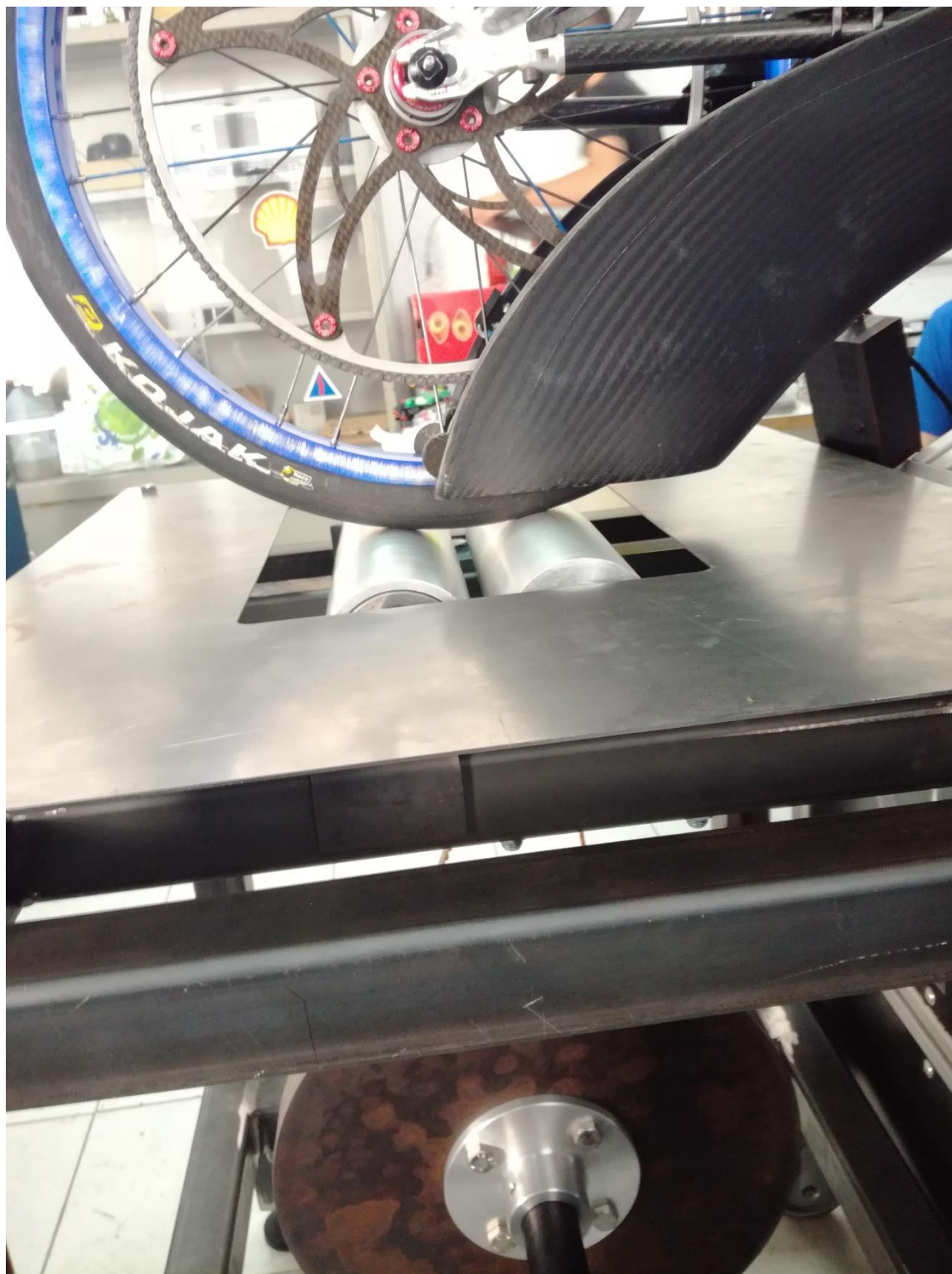
Εικόνα 141: Επαφή τροχού οχήματος Orca με τα ράουλα δυναμομέτρησης.
