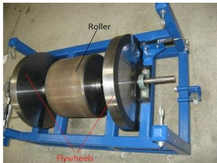
Εικόνα 8: Αδρανειακό δυναμόμετρο με επίτευξη της αδράνειας μέσω βάρους.
