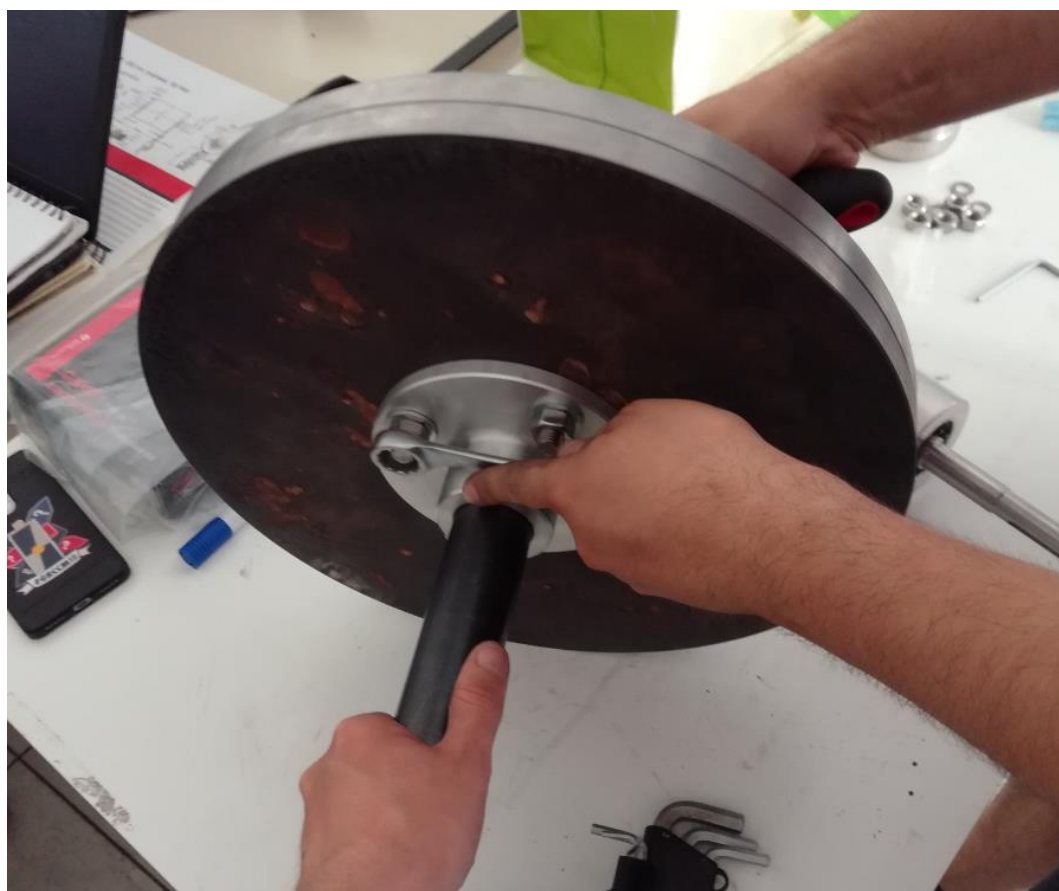
Εικόνα 123: Συναρμολόγηση POS20_CD_FLYWHELL SUB ASSEMBLY.
