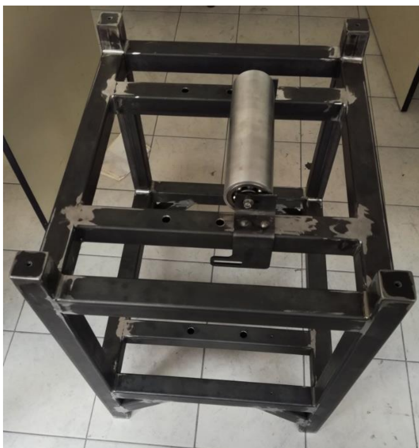
Εικόνα 115: Μεταλλικό πλαίσιο και βοηθητικό ράουλο (POS20_CD_REAR DRUM_SUB ASSEMBLY).
