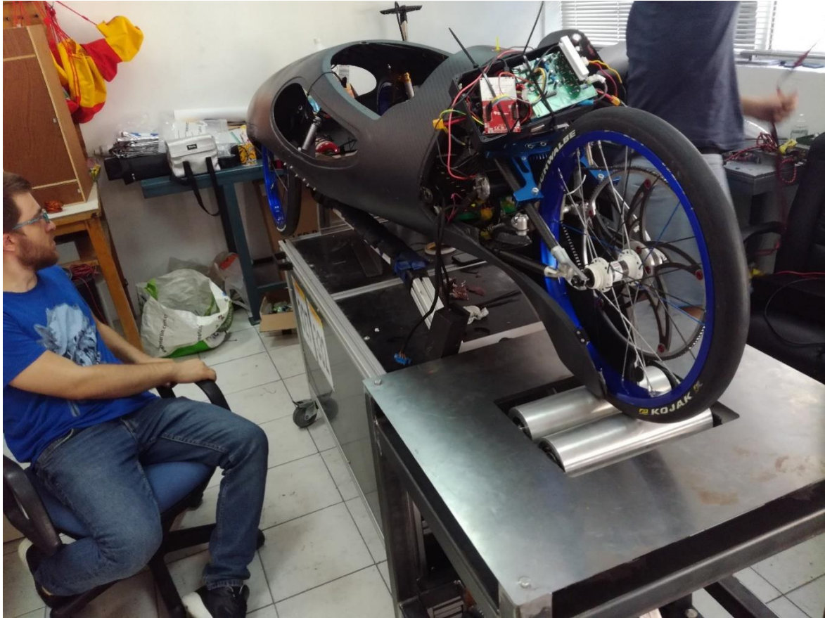
Εικόνα 144: Όχημα Orca επάνω στην αδρανειακή δυναμοτράπεζα.
