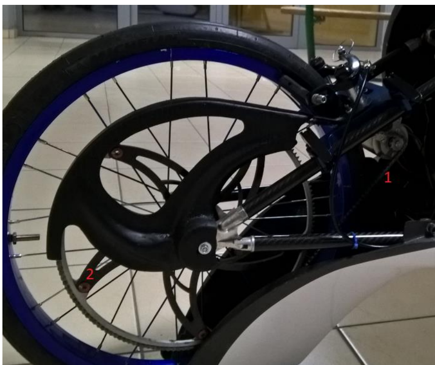
Εικόνα 13: Σύστημα μετάδοσης οχήματος Orca. Όπου (1) ο κινητήριος αλυσοτροχός και (2) το μεγάλο γρανάζι.
