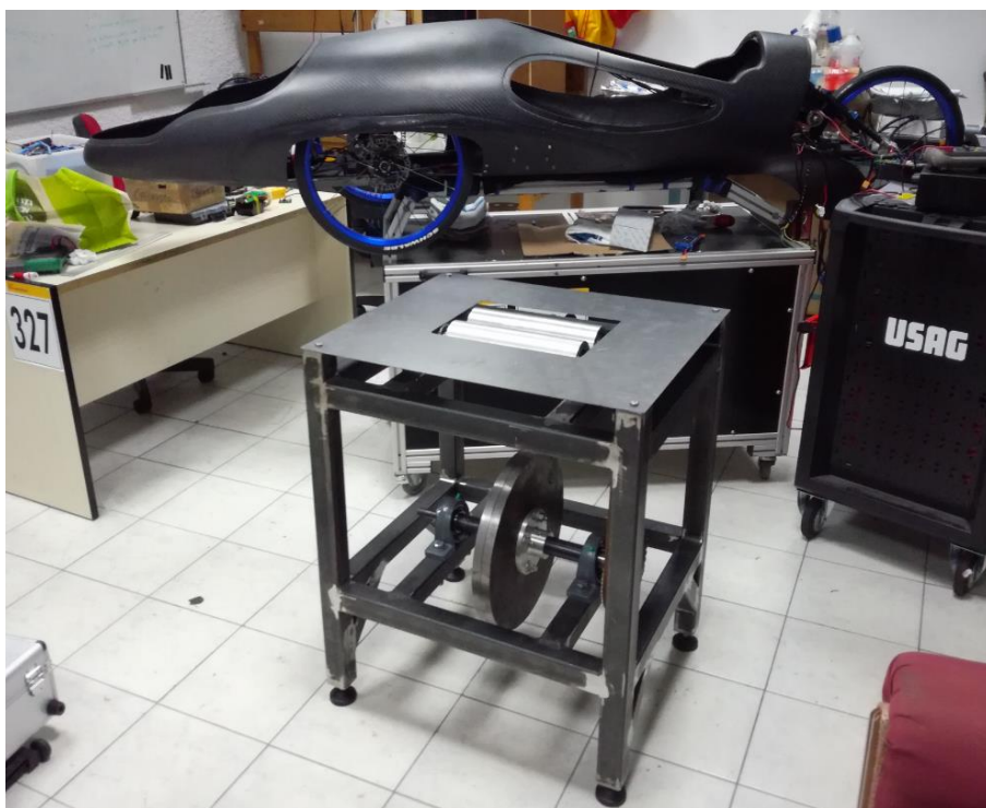
Εικόνα 136: Διάταξη δυναμομέτρησης και όχημα Orca.
