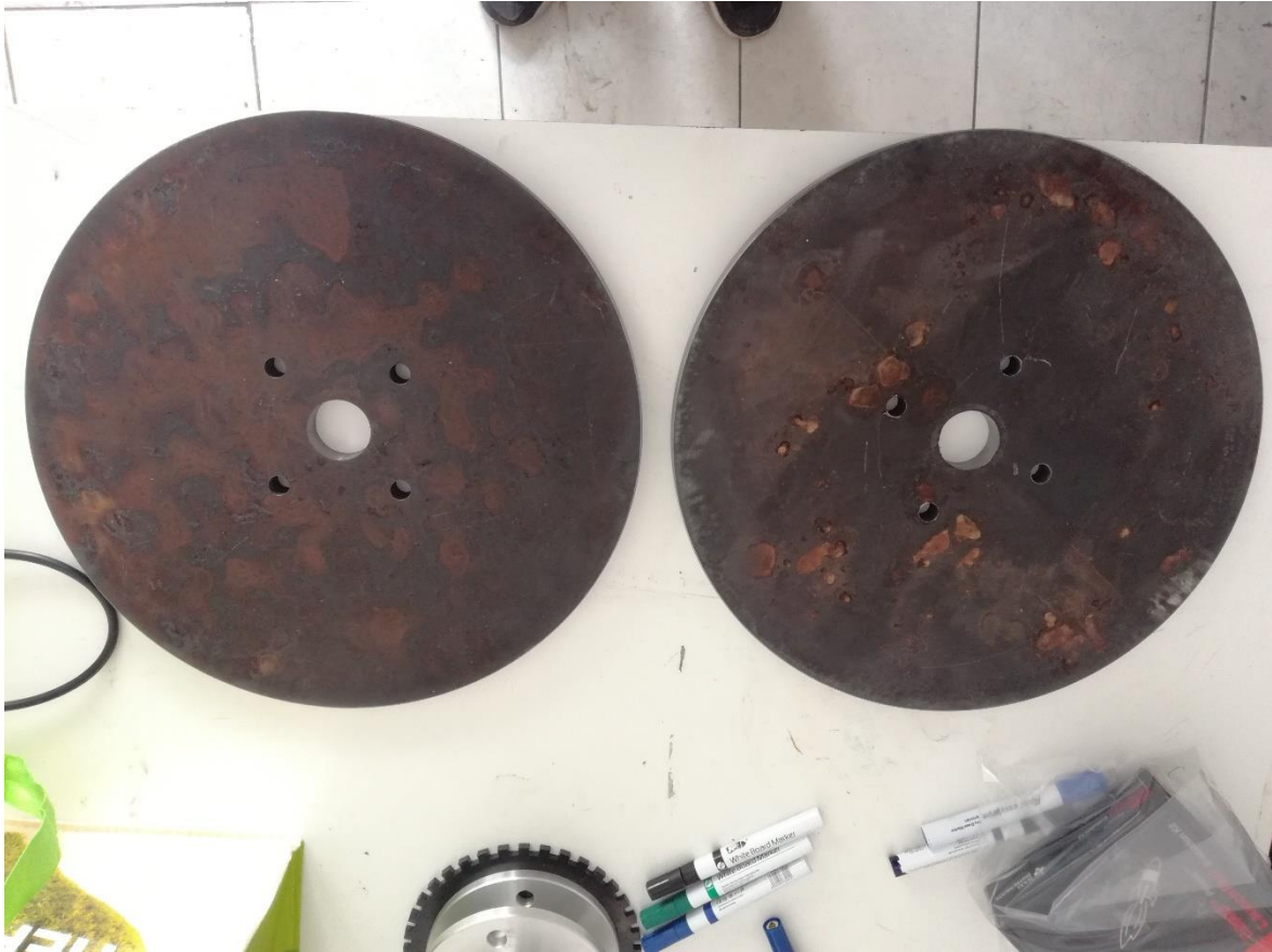
Εικόνα 118: Αδρανειακές πλάκες (POS20_CD_STL_FLYWHEEL).
