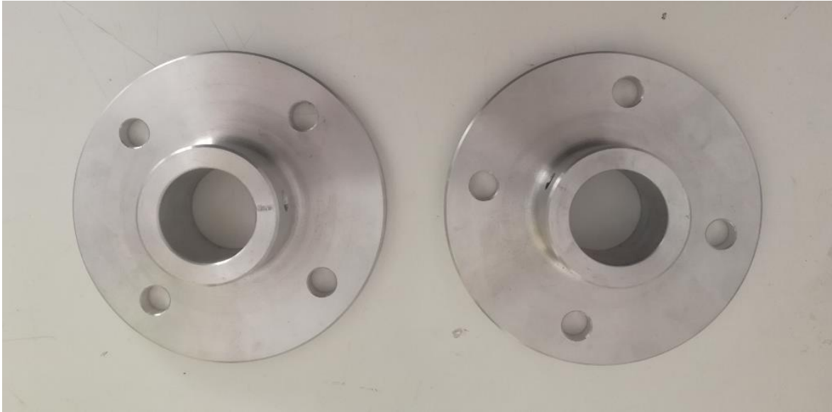
Εικόνα 120: Φλάντζες συγκράτησης αδρανειακών πλακών με τον άξονα στήριξης.
