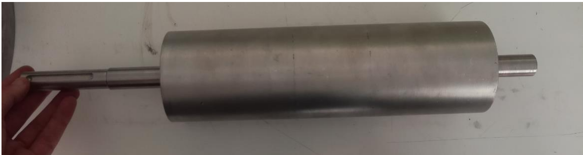
Εικόνα 125: Εμπρόσθιο ράουλο POS20_CD_FRONT DRUM_SUB ASSEMBLY.
