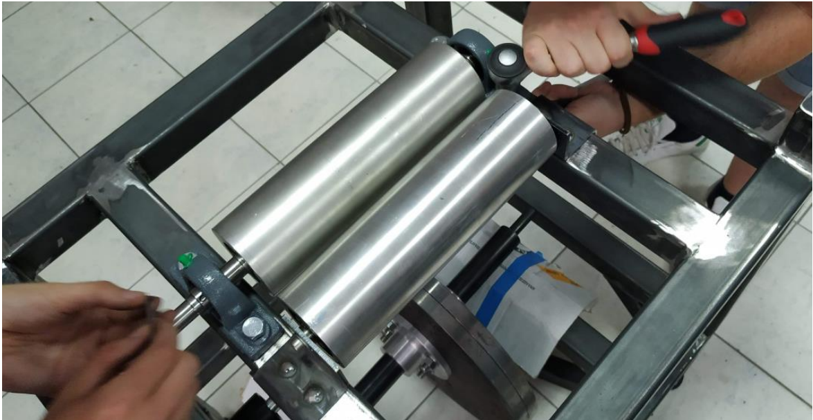
Εικόνα 130: Πρόσδεση εμπρόσθιου ράουλου με τα ρουλεμάν UCP204.
