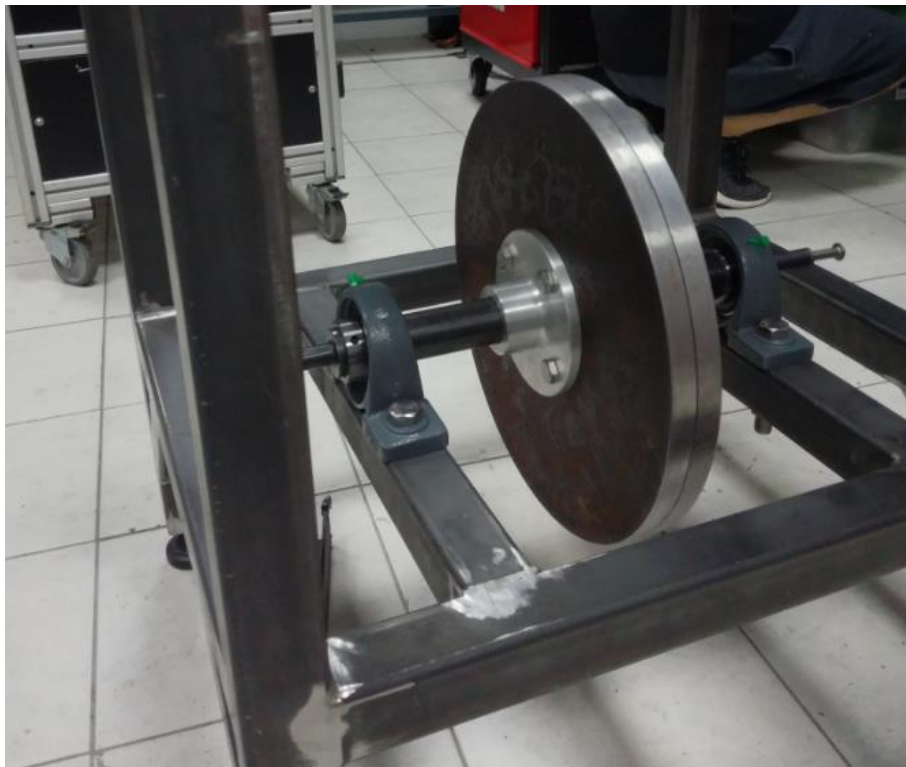
Εικόνα 129: Στήριξη άξονα αδρανειακής μάζας στο μεταλλικό πλαίσιο
