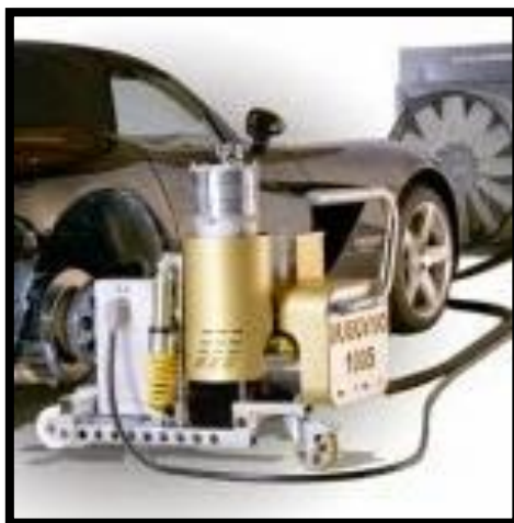
Εικόνα 12: Δυναμόμετρο πλήμνης ή μουαγιέ.
