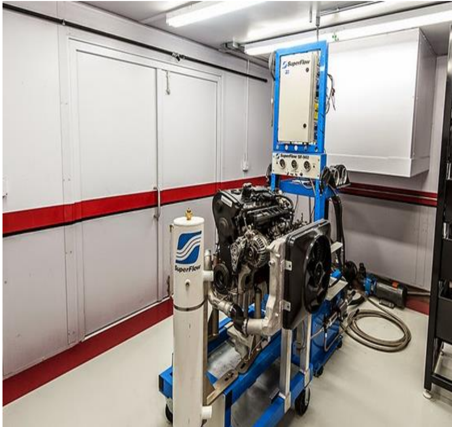
Εικόνα 11: Διάταξη δυναμομέτρησης στον κινητήρα του οχήματος, Dusseldorf, Germany.
