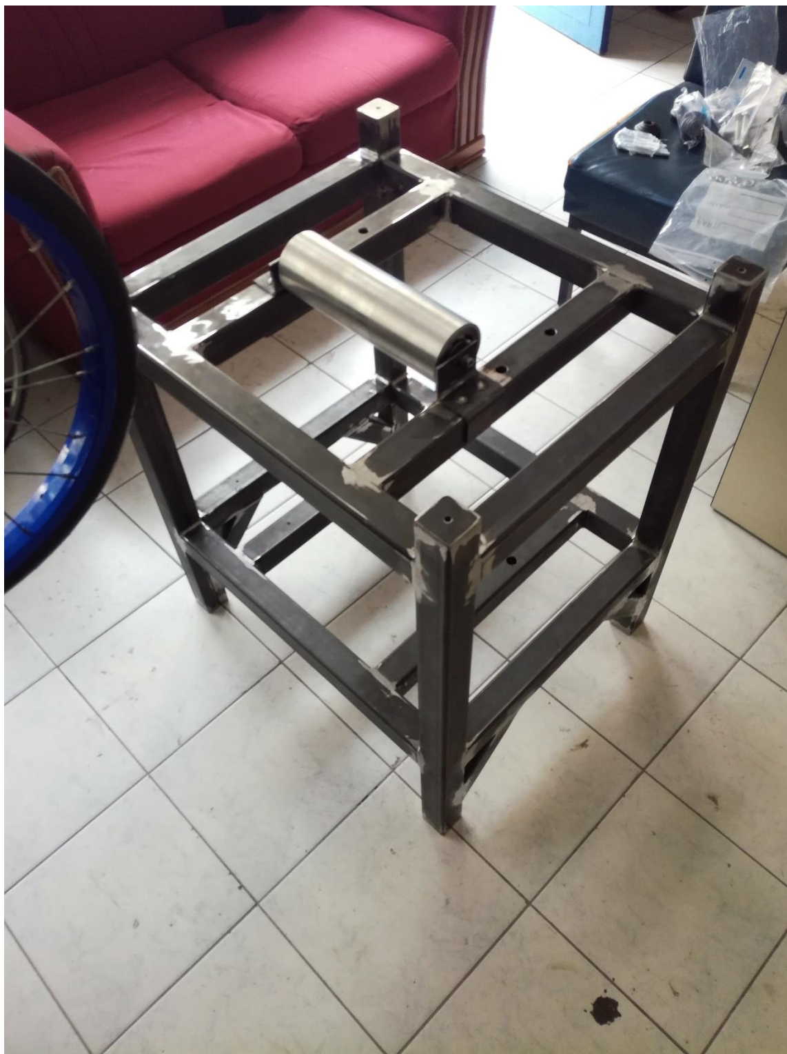
Εικόνα 116: Μεταλλικό πλαίσιο και βοηθητικό ράουλο.
