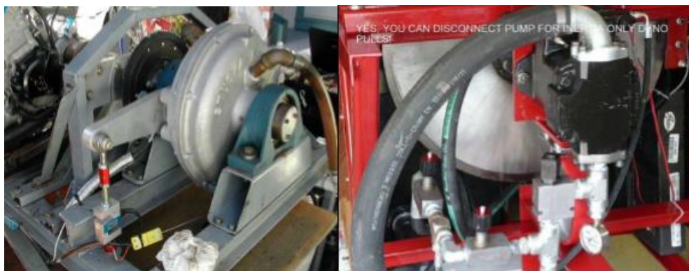
Εικόνα 10: Στα αριστερά φαίνεται διάταξη με water brake ενώ στα δεξιά διάταξη με hydraulic brake.
