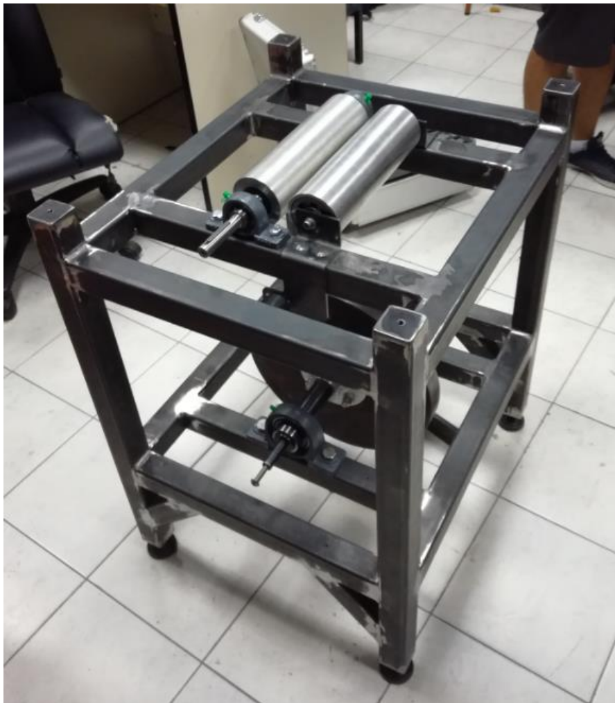
Εικόνα 133: Στήριξη εμπρόσθιου ράουλου (POS20_CD_FRONT DRUM_SUB ASSEMBLY).
