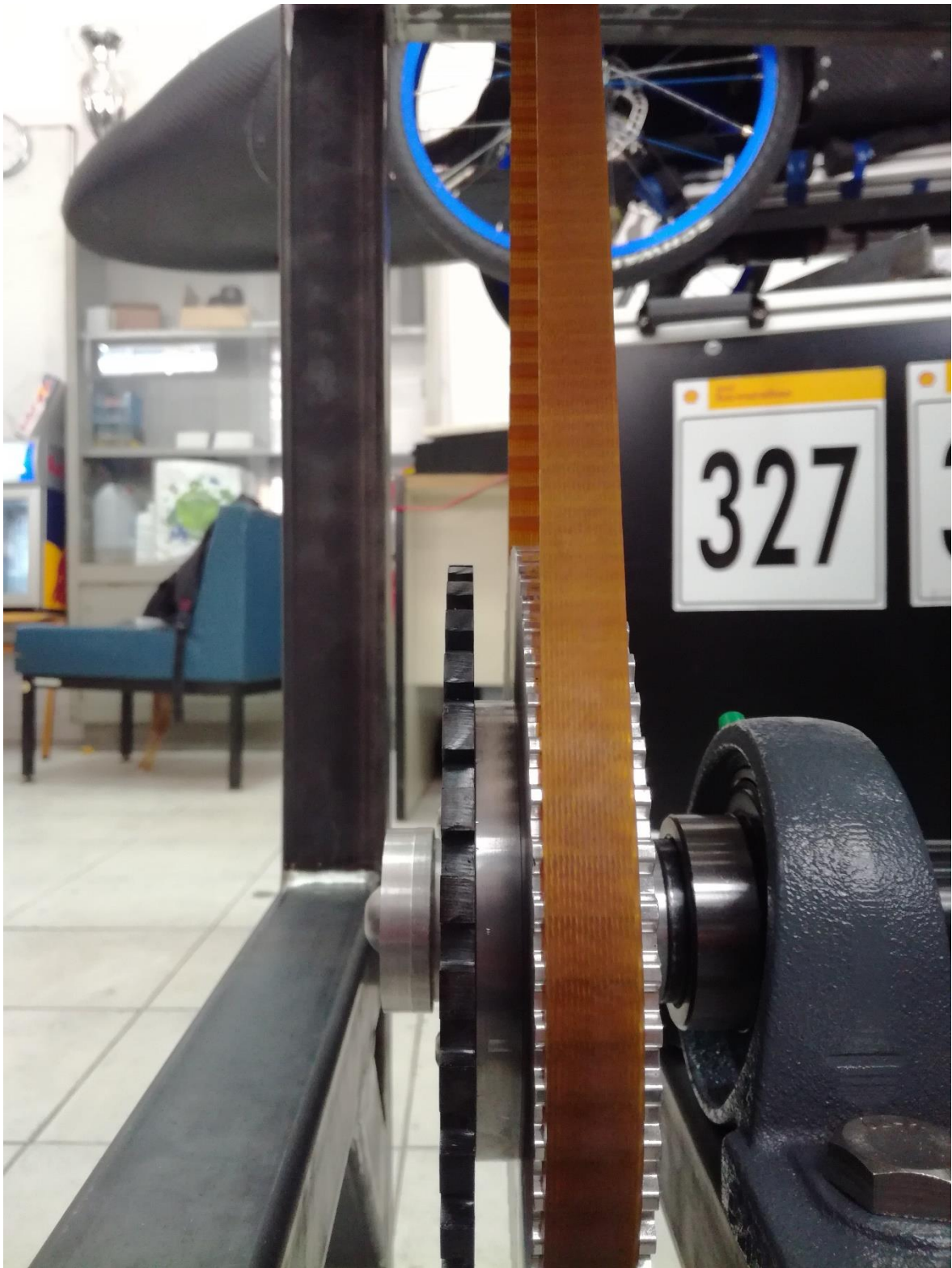
Εικόνα 139: Γρανάζι αδρανειακού άξονα και δίσκος μέτρησης των στροφών.
