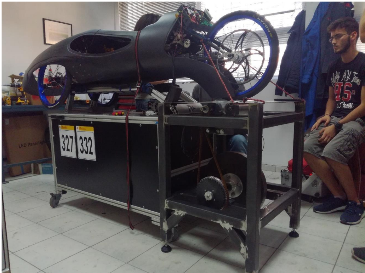
Εικόνα 145: Φωτογραφία λίγο πριν την πρώτη δοκιμή της δυναμοτράπεζας.
