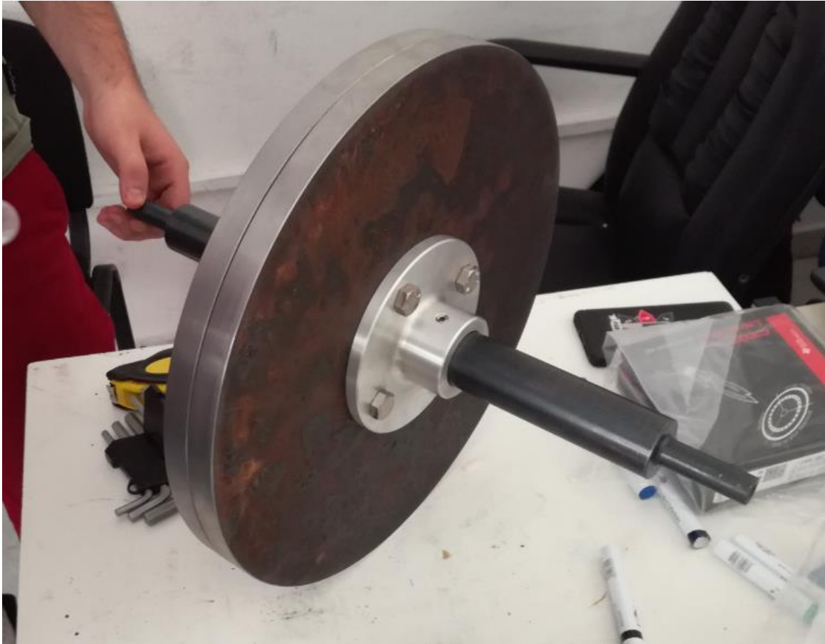
Εικόνα 124: Τελικό Συναρμολόγημα. POS20_CD_FLYWHELL SUB ASSEMBLY.
