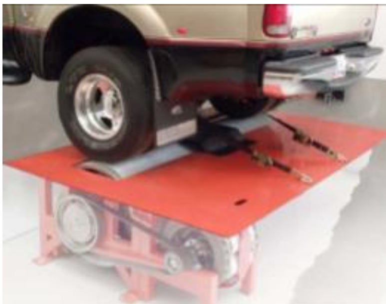
Εικόνα 6: Όχημα επάνω στην διάταξη αδρανειακού δυναμομέτρου.
