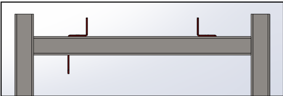
Εικόνα 62: Πρόοψη. Βάσεις βοηθητικού ράουλου στο σασί.
