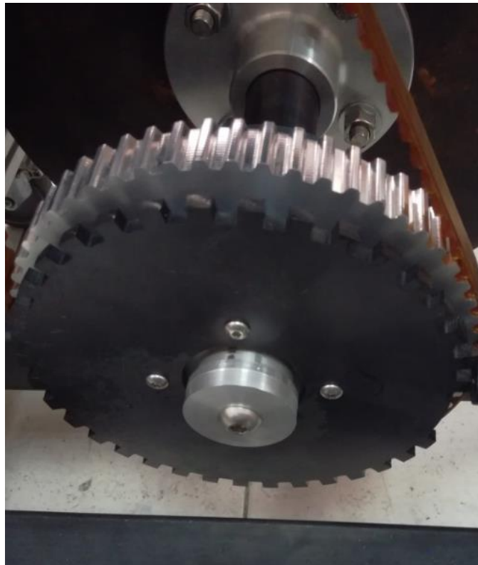
Εικόνα 138: Γρανάζι αδρανειακού άξονα και δίσκος μέτρησης των στροφών.
