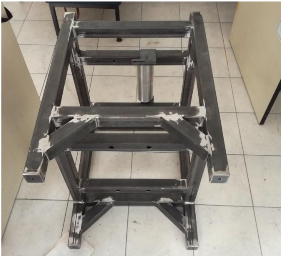
Εικόνα 113: Μεταλλικό Πλαίσιο δυναμοτράπεζας (POS20_CD_STL_CHASSIS)
