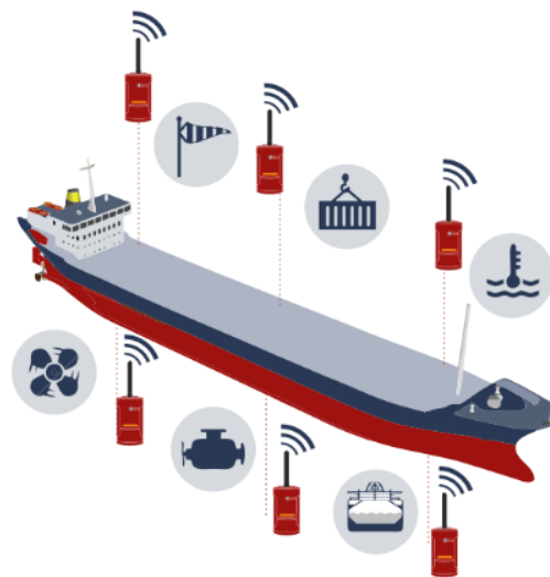
Εικόνα 4. Ο έλεγχος μέσω RFID όλων των κρίσιμων συστημάτων ενός πλοίου.
