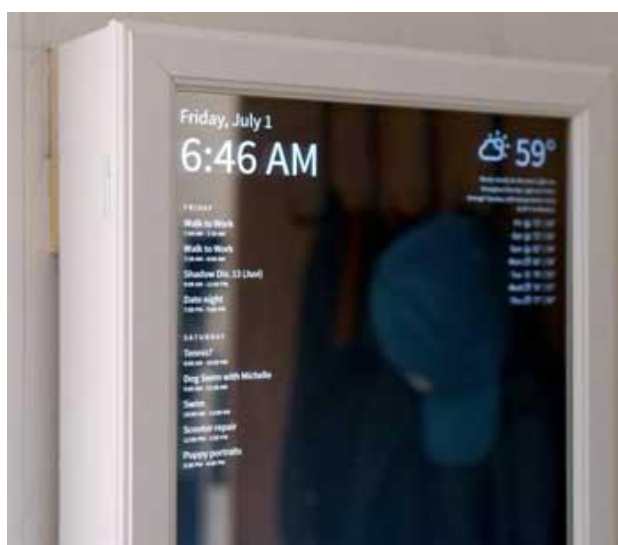
4.1 Έξυπνος καθρέφτης με γυαλί και ακρυλικό φύλλο
