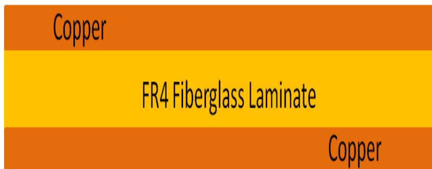
13α. Πλάγια όψη ελασματοποιημένου πολυστρωματικού υλικού τύπου FR-4
