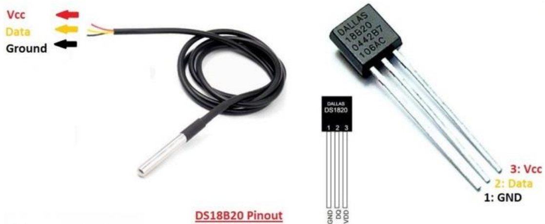
19. Διάγραμμα ακίδων εξόδου αισθητήρα θερμοκρασίας DS18B20
