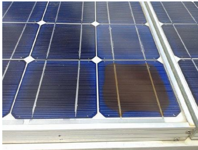
Εικόνα 1.8: Οξείδωση Φ/Β κελιού τετράγωνου σχήματος
