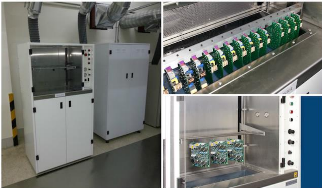
Εικόνα 5.9: Σύστημα εναπόθεσης μέσω βύθισης για την επεξεργασία παρτίδων τυπωμένων κυκλωμάτων μεσαίας έως μεγάλης ποσότητας [5.29].
