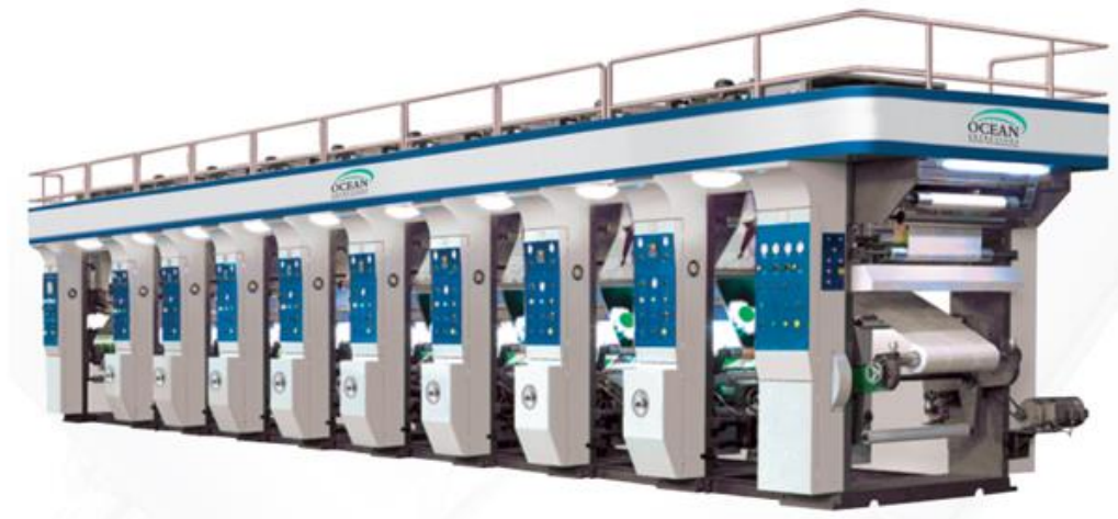
Εικόνα 5.21: Σύστημα εκτύπωσης gravure για βιομηχανικές εφαρμογές [5.59].
