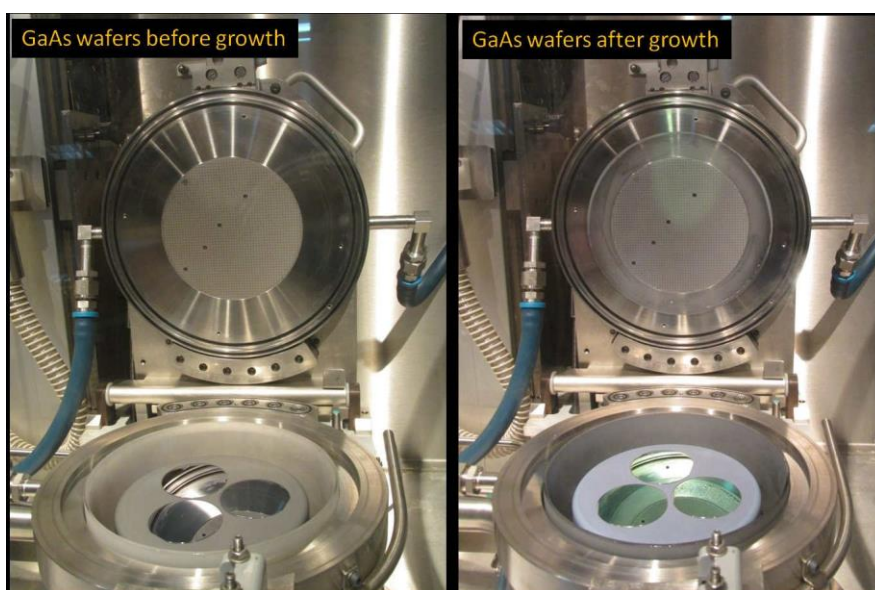
Εικόνα 4.16: GaAs υποστρώματα εντός του αντιδραστήρα MOCVD πριν και μετά την ανάπτυξη της δομής DBR [4.40].
