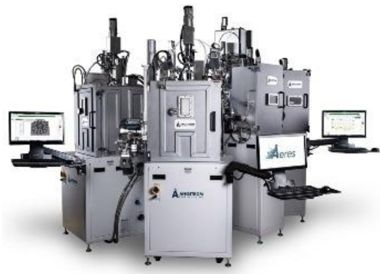
Εικόνα 1.10: Αυτοματοποιημένο σύστημα κενού με δυνατότητα χειρισμού πολλών δειγμάτων σε κάθε μονάδα, με τη βοήθεια ενός κεντρικού ρομπότ [1.34].
