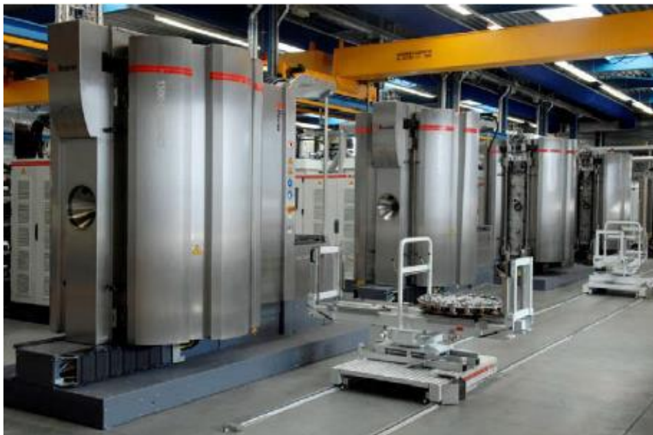
Εικόνα 4.19: Βιομηχανικό σύστημα εναπόθεσης πολλαπλών ζωνών για την κατασκευή επικαλύψεων DLC για εξαρτήματα αυτοκινήτων και άλλες εφαρμογές [4.48].
