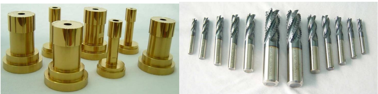
Εικόνα 3.9: (Αριστερά) επικαλύψεις με νιτρίδιο του τιτανίου (TiN) και (δεξιά) επικαλύψεις με νιτρίδιο αργιλίου τιτανίου (AlTiN) χρησιμοποιώντας την τεχνική καθοδικής εκκένωσης τόξου [3.30].
