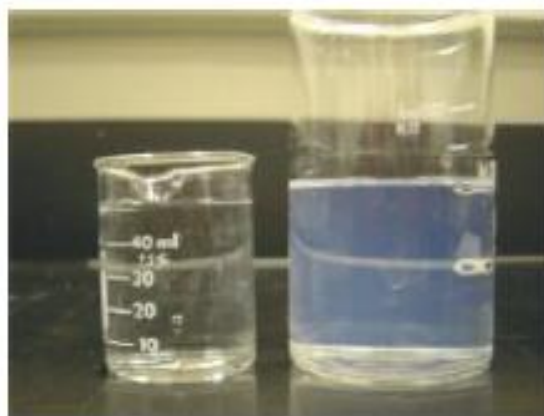
Εικόνα 5.3: Ζύμωση: \text{TiO}_2 από το κολλοειδές (αριστερά) έως το υγρό πήκτωμα (δεξιά) [5.11].
