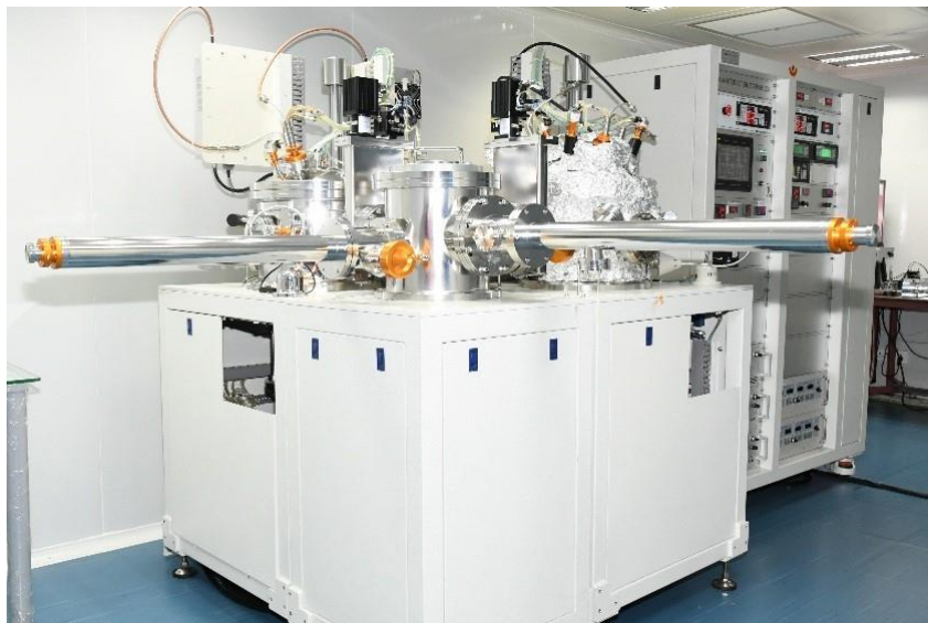
Εικόνα 2.8: Θάλαμος διπλής λειτουργίας (DC-RF) μαγνητικά υποβοηθούμενης ιοντοβολής [2.24].
