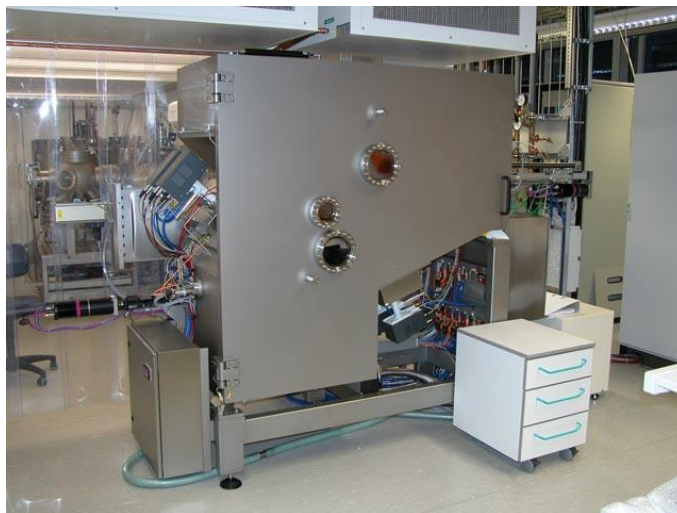
Εικόνα 2.8: Σύστημα ιοντοβολής δέσμης ιόντων υψηλή κενού, για ακριβείς επιστρώσεις και διαδικασίες χάραξης [2.28].
