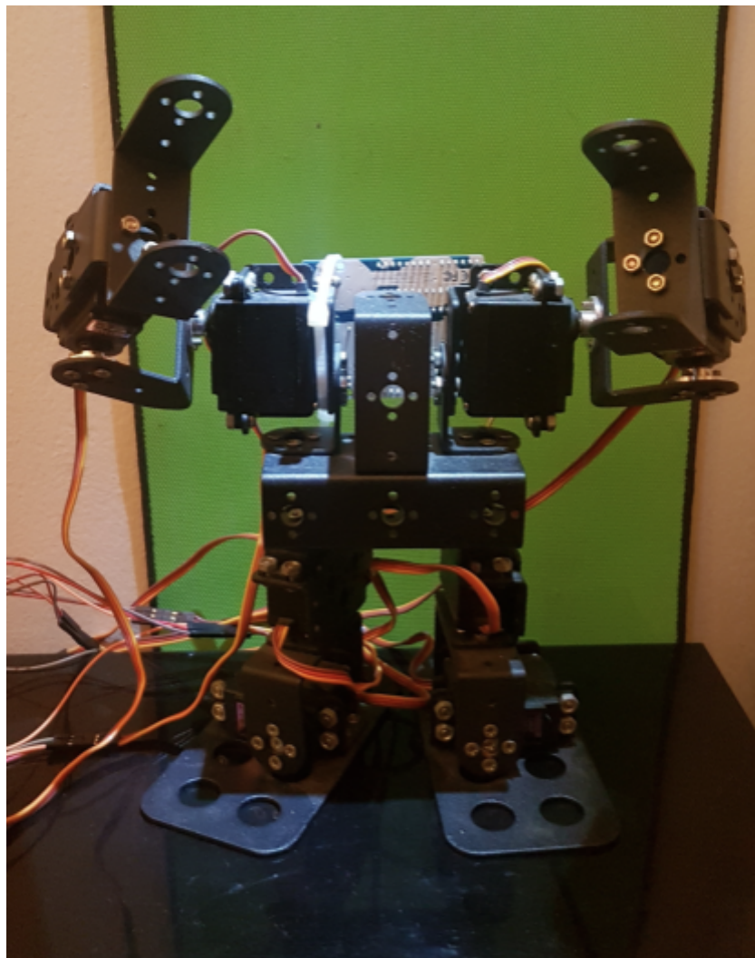
Εικόνα 3.4 Biped robot (9DOF) που χρησιμοποιήθηκε στην εργασία
