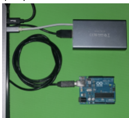
Εικόνα 5.1 Σύνδεση Arduino με υπολογιστή μέσω USB
