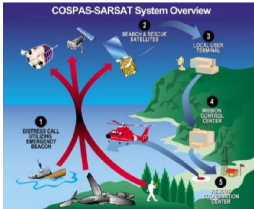
Διάγραμμα 6. Σχηματική απεικόνιση ενός συστήματος COMPAS – SARSAT
