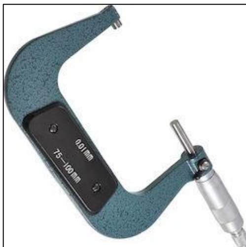
Εικόνα 4.2: Μικρόμετρο τιμών 75-100mm ακρίβειας 0.01mm
