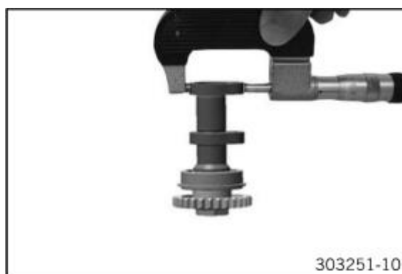
Σχήμα 4.5: Έλεγχος διαμέτρου έκκεντρων
