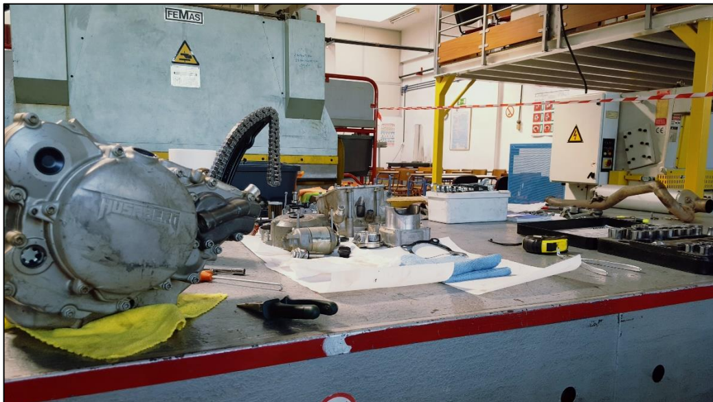
Εικόνα 5.4: Τοποθέτηση αντλίας νερού και εξωτερικών καλυμμάτων
