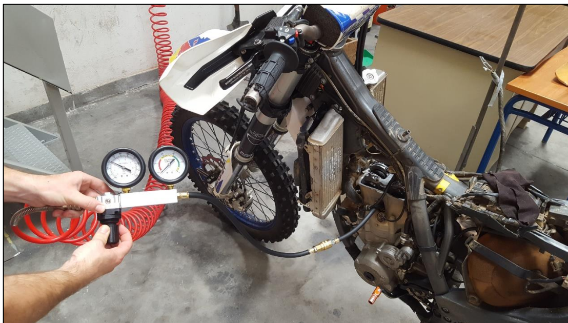
Εικόνα 2.5: Διαδικασία ελέγχου διαρροών κυλίνδρου
