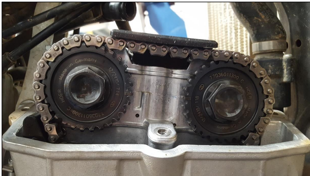
Εικόνα 3.6: Σημάδια χρονοισμού εκκεντροφόρων
