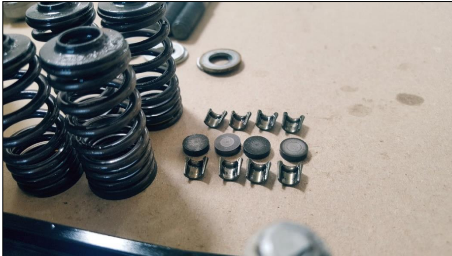
Εικόνα 4.8: Έλεγχος ελατηρίων, ασφαλειών και ωστηρίων
