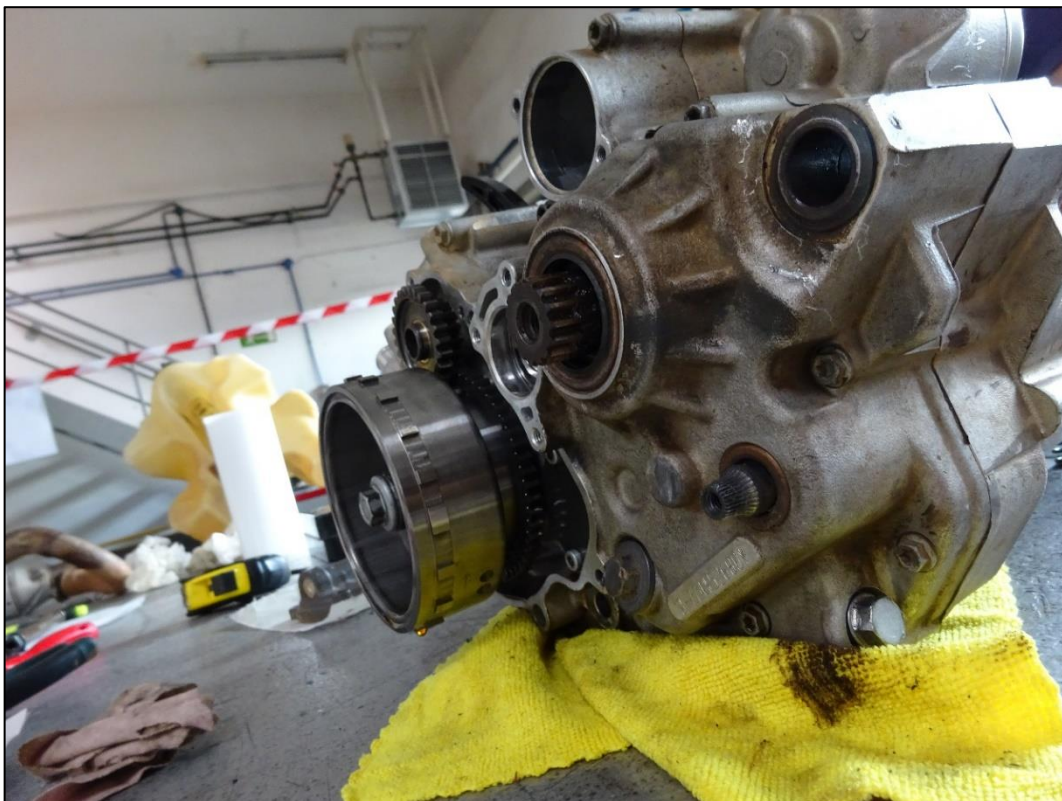
Εικόνα 3.5: Όψη πηλιοφόρου, αντλίας συμπλέκτη και γραναζιού μετάδοσης κίνησης
