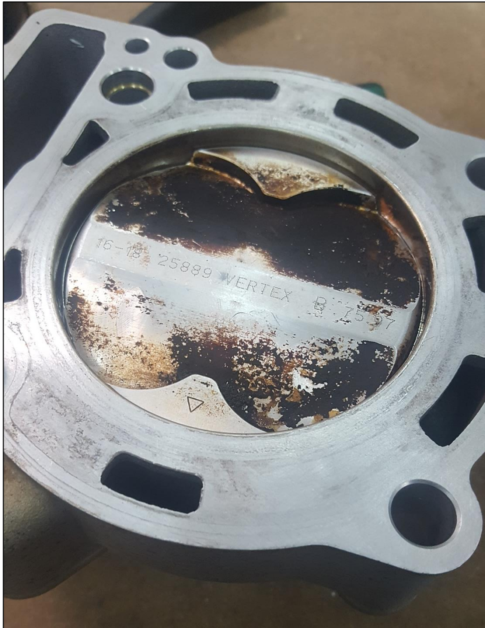
Εικόνα 5.6: Εισαγωγή εμβόλου στον κύλινδρο με τη σωστή φορά
