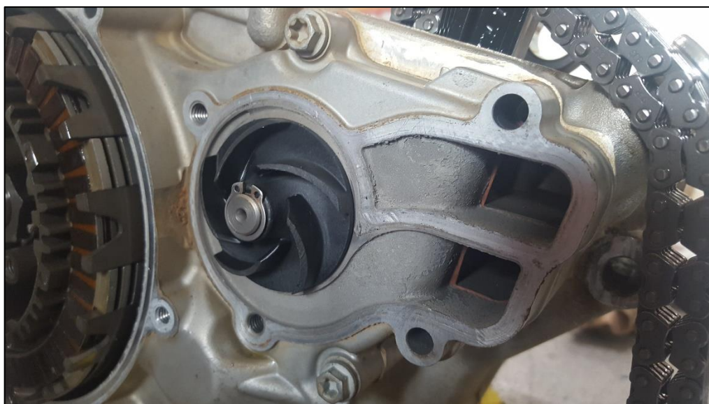
Εικόνα 4.5: Οπτικός έλεγχος πτερυγίου αντλίας νερού
