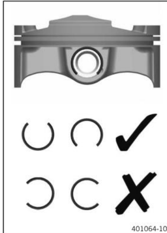
Σχήμα 5.1: Φορά ασφάλειας πύρου εμβόλου
