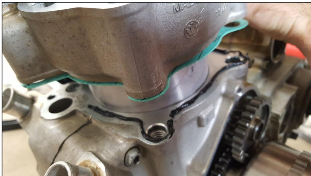
Εικόνα 5.7: Εφαρμογή στεγανοποιητικής κόλλας
