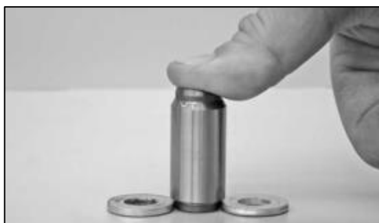
Σχήμα 5.7: Οπλισμός τεντωτήρα καδένας
