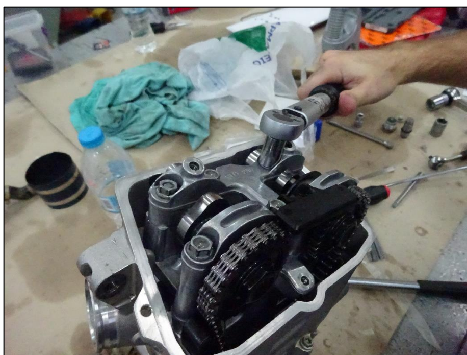
Εικόνα 5.14: Σύσφιξη κοχλιών με ροπόκλειδο
