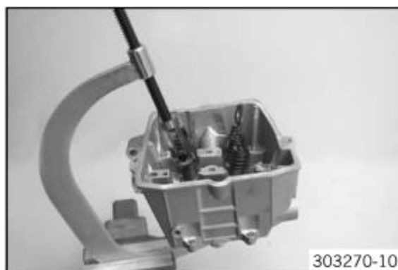
Σχήμα 4.6: Εξαγωγή βαλβίδων με εξωλκέα
