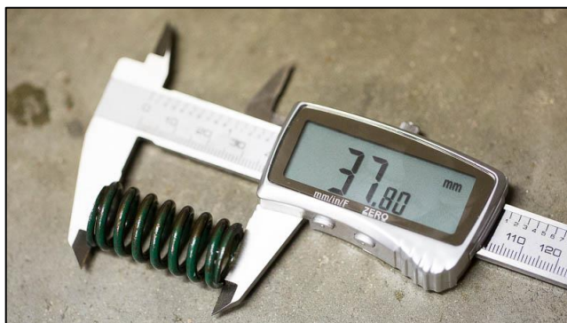
Εικόνα 4.4: Μέτρηση ελατηρίων συμπλέκτη με παχύμετρο
