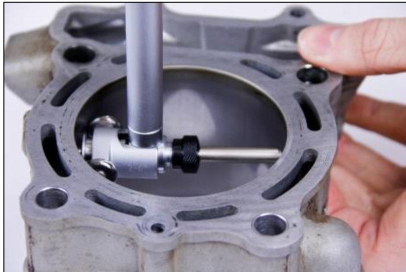
Εικόνα 4.6: Διαδικασία μέτρησης διαμέτρου κυλίνδρου
