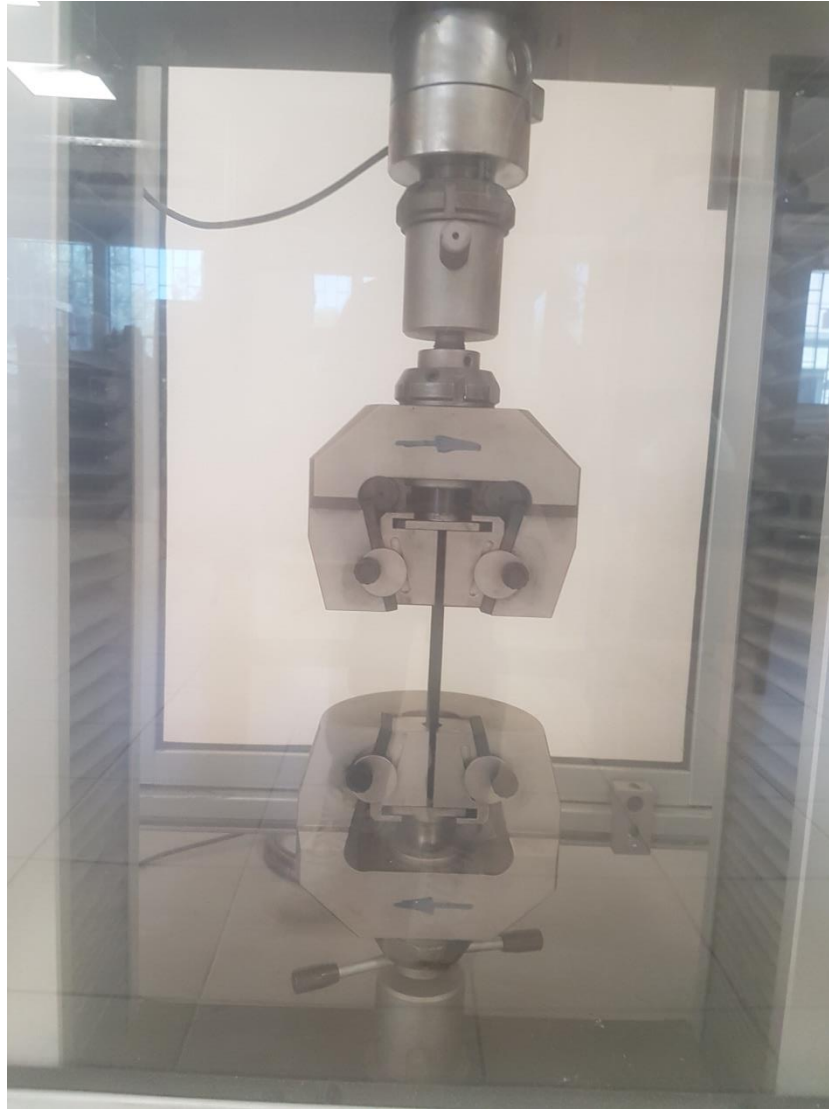
Εικόνα 53 Μηχάνημα Quasar 100 και τοποθετημένο το δοκίμιο πριν την έναρξη του πειράματος του εφελκυσμού
