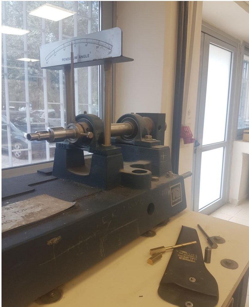
Εικόνα 40 Μηχάνημα στρέψης όπου πραγματοποιήθηκε το πείραμα
