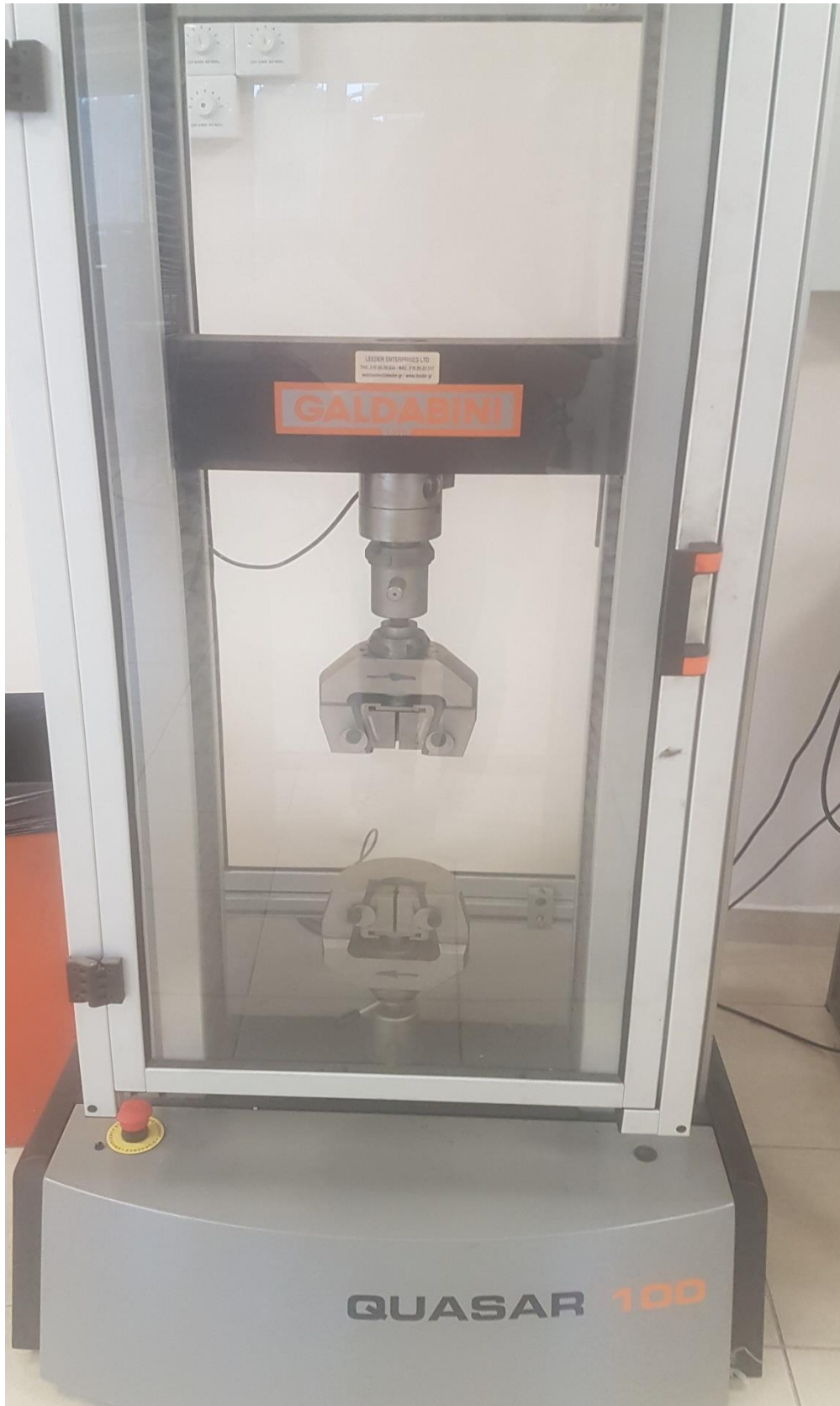
Εικόνα 51 Μηχάνημα QUASAR 100 για το πείραμα του εφελκυσμού
