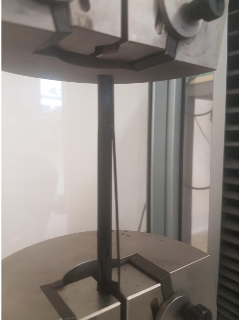
Εικόνα 56 Τελικό αποτέλεσμα εφελκυσμού - θράυση δοκιμίου
