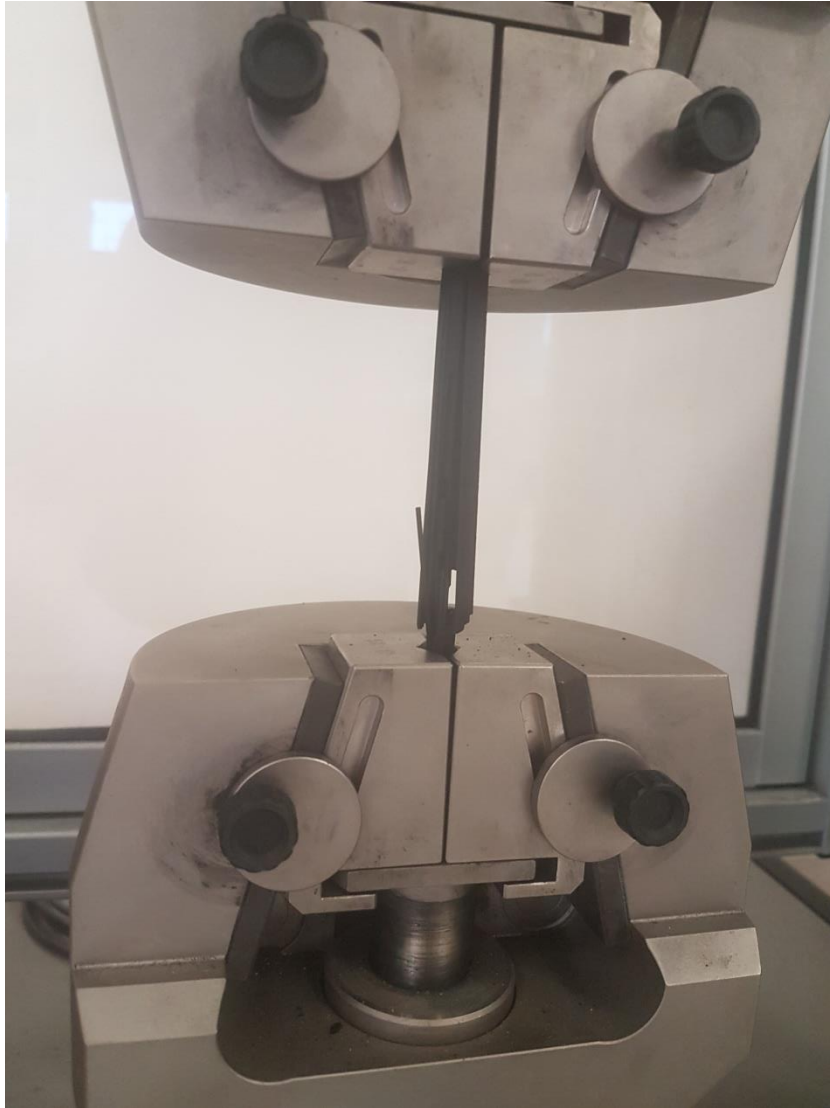
Εικόνα 54 Εφελκυσμός - θραύση δοκμίου
