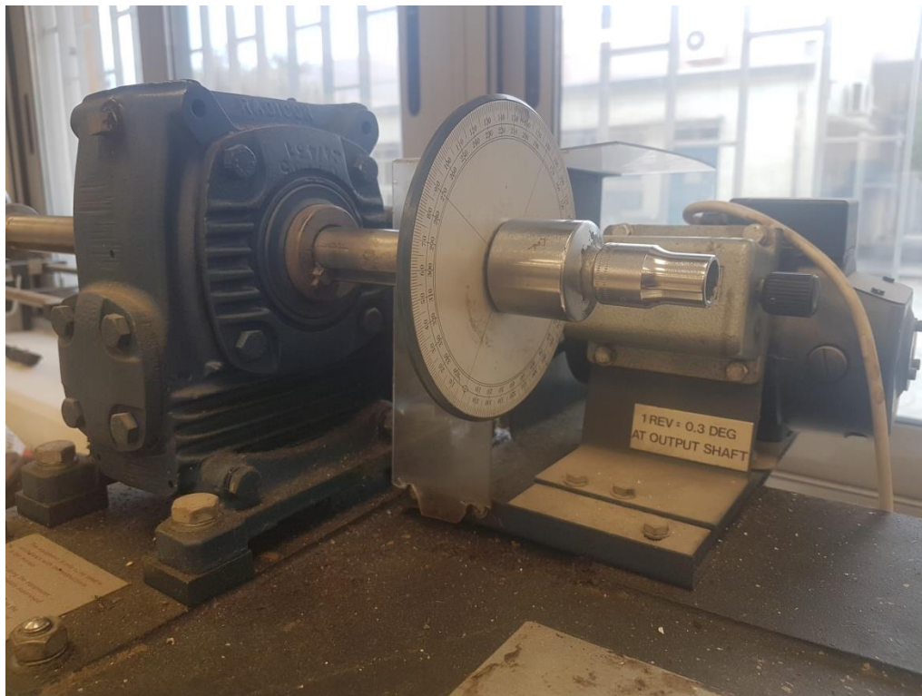
Εικόνα 38 Μηχάνημα στρέψης όπου πραγματοποιήθηκε το πείραμα
