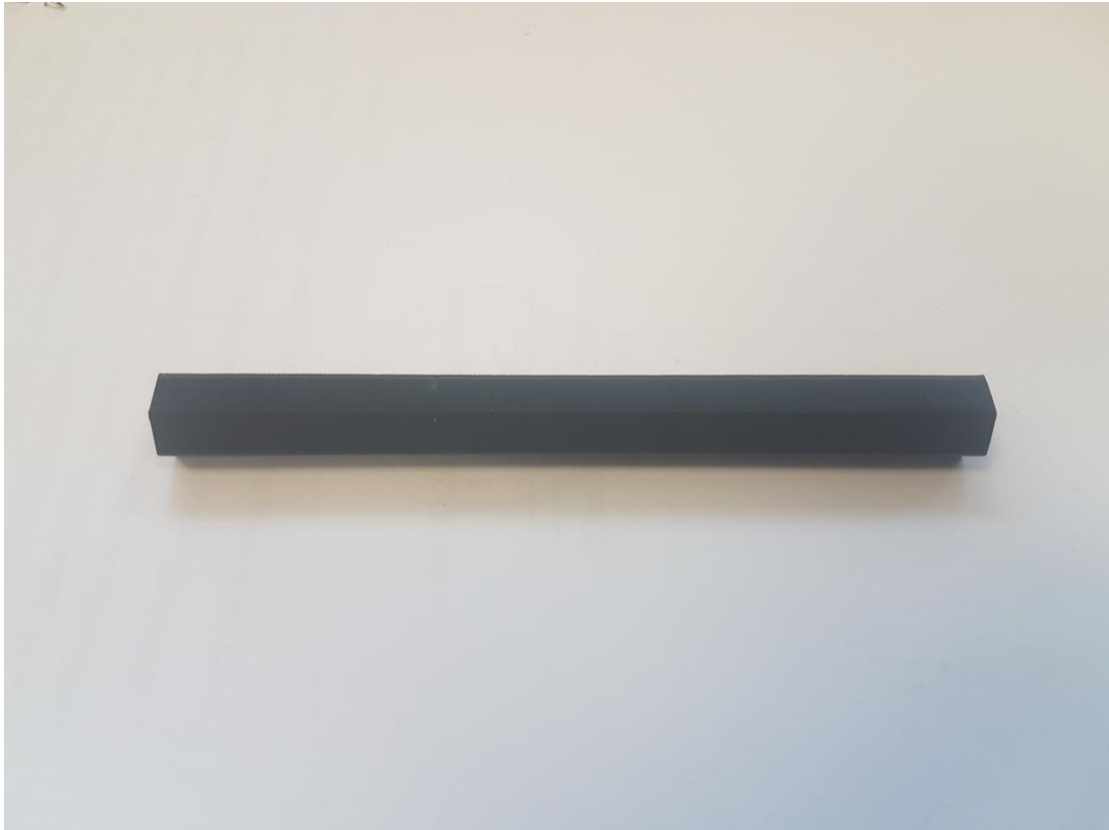
Εικόνα 37 Εξαγωνικό δοκίμιο - αποτέλεσμα τύπωσης
