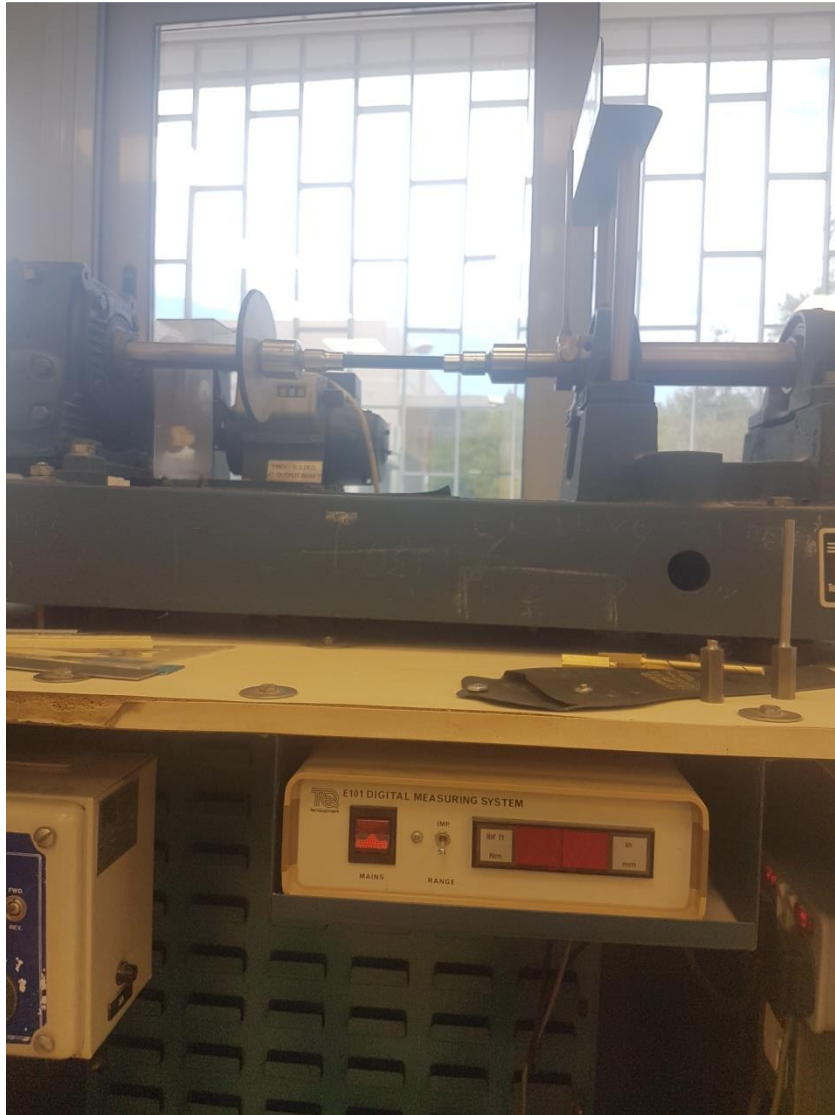
Εικόνα 41 Μηχάνημα στρέψης και εξαγωνικό δοκίμιο πριν την έναρξη του πειράματος
