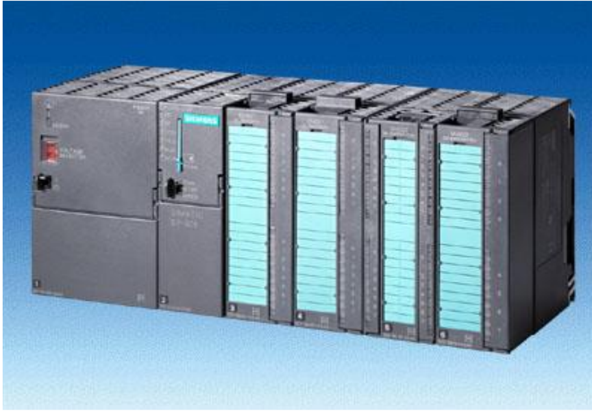
Εικόνα 6.6 PLC SIEMENS SIMATIC S7-300. [22].
