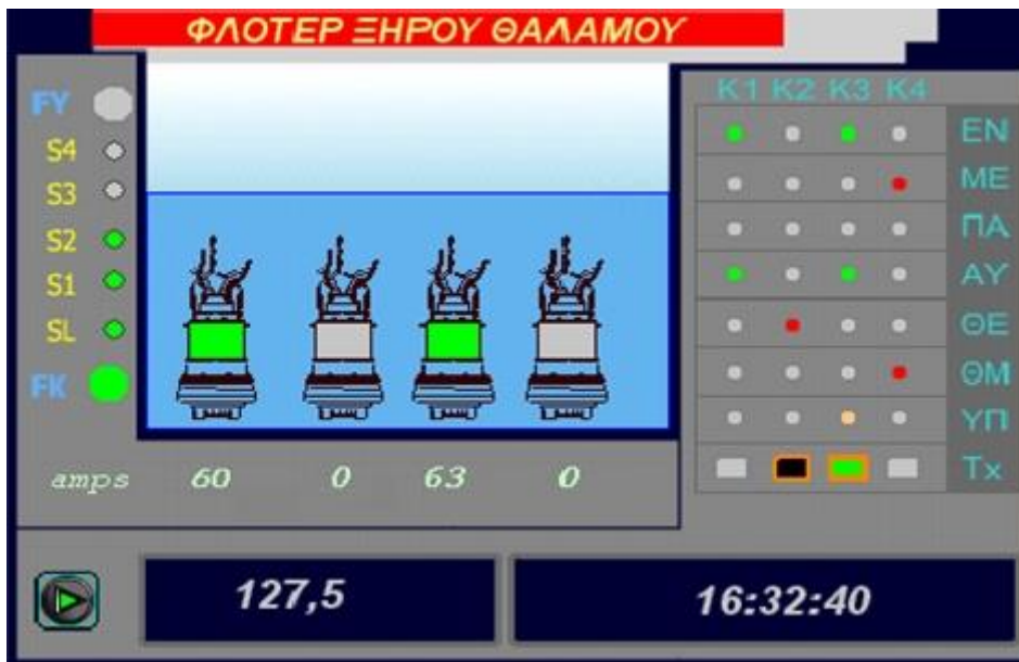
Εικόνα 9.2 Σύστημα HMI-απεικόνιση διεργασίας δικτύου αποχέτευσης. [32].
