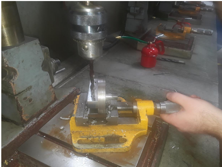
Εικόνα 18. Διάτρηση οπής \varnothing 6,8 σε δράπανο
