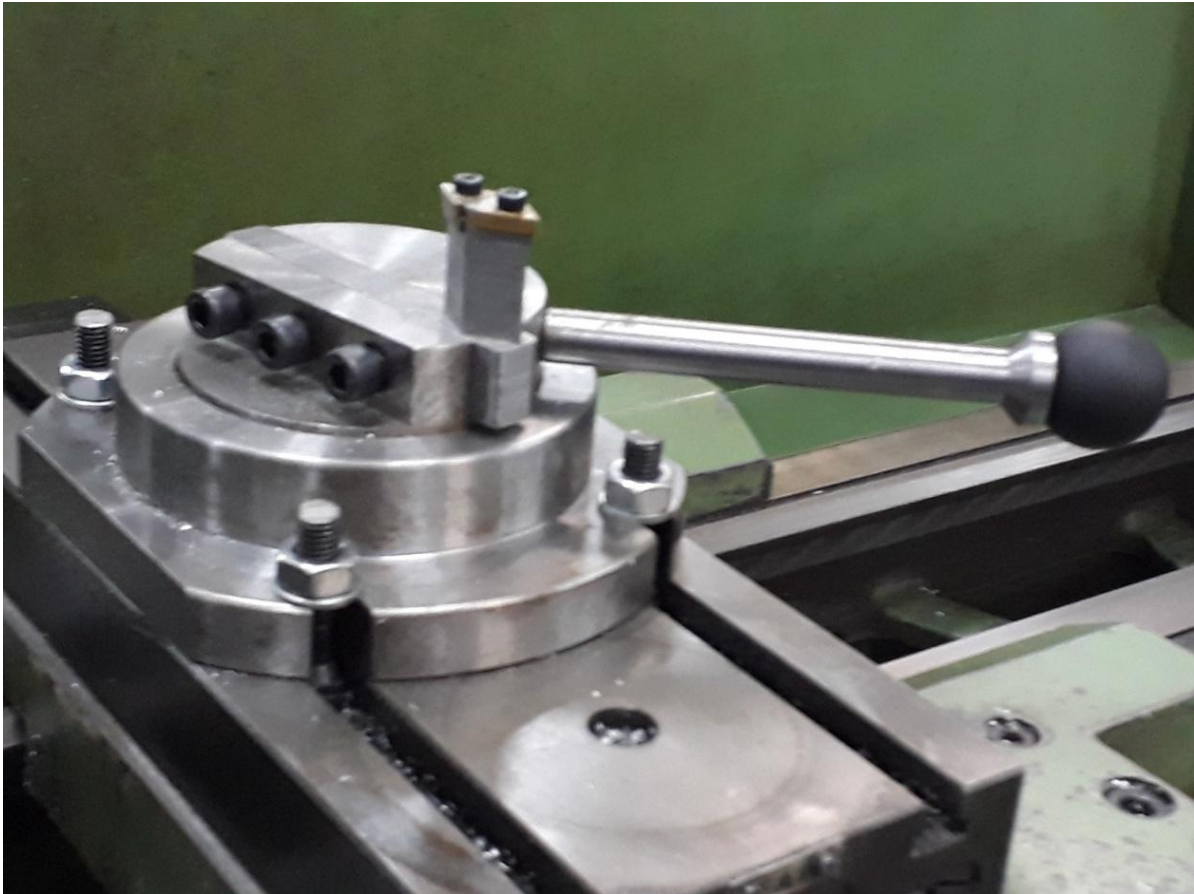
Εικόνα 11. Συναρμολόγηση και τοποθέτηση της ιδιοσυσκευής στο εργαλειοφορείο ενός συμβατικού τόρνου
