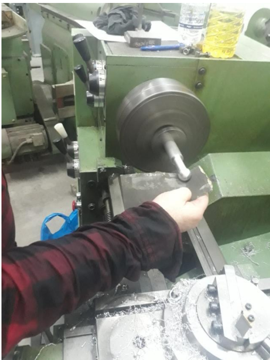
Εικόνα 38. Λείανση σφαίρας με σμυριδόπανο
