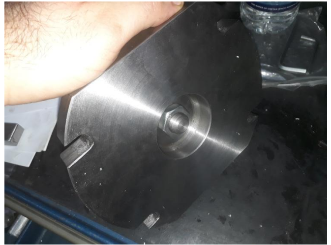
Εικόνα 28. Σύσφιξη περικοχλίου M16
