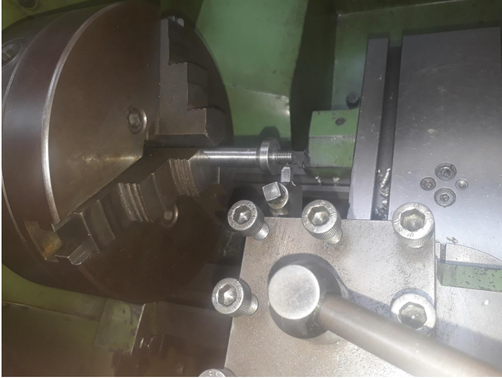
Εικόνα 25. Κοπή σπειρώματος M10 (x1,5) σε τόρνο
