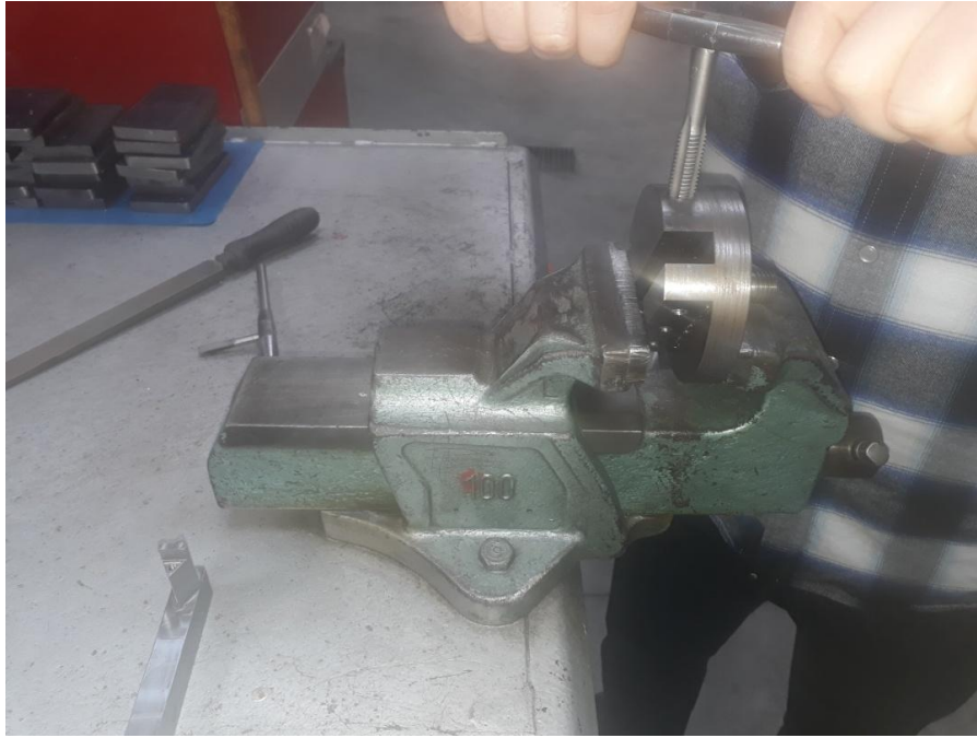
Εικόνα 21. Σπειροτόμηση M12 (x1,75)
