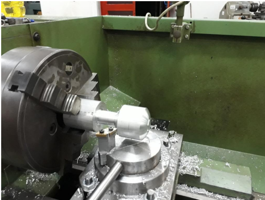
Εικόνα 41. Διαμόρφωση σφαιρικής επιφάνειας σε αρχικό στάδιο
