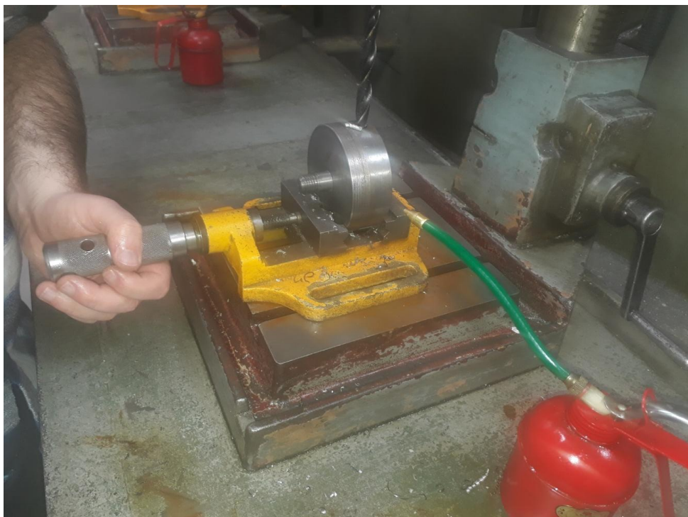
Εικόνα 20. Διάτρηση οπής \varnothing 10,2 σε δράπανο
