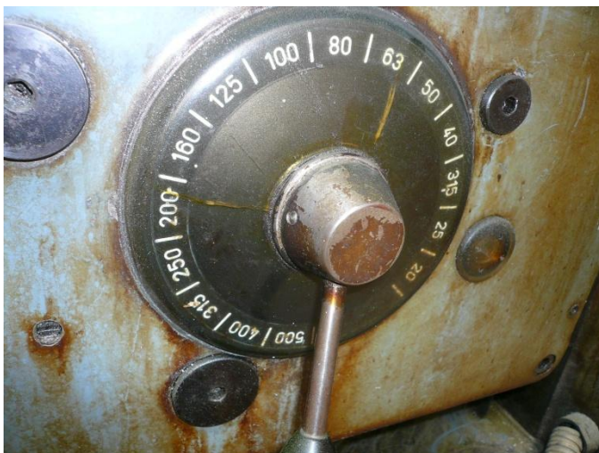
Εικόνα 57. Τιμές ταχυτήτων πρόωσης φρέζας
