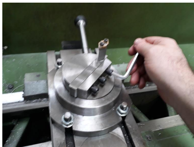
Εικόνα 32. Σύσφιξη κοχλίων M8
