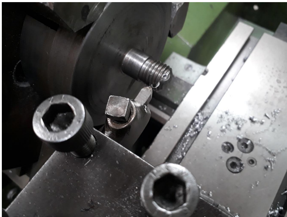
Εικόνα 16. Κοπή σπειρώματος M16 (x2) σε τόρνο
