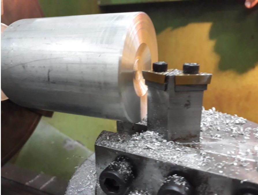
Εικόνα 52. Περιορισμός περαιτέρω κατεργασίας λόγω επαφής μανέλας – τεμαχίου
