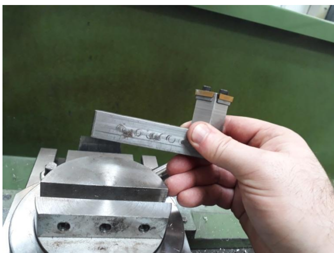
Εικόνα 33. Μανέλα με ενσωματωμένα υπόβαθρα και κοπτικά εργαλεία
