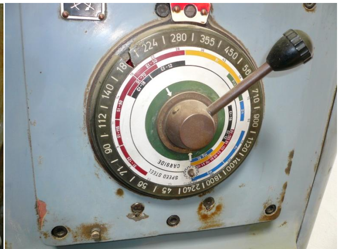
Εικόνα 56. Στροφές κύριας ατράκτου φρέζας
