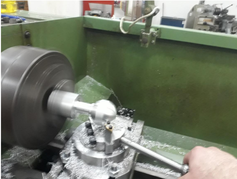
Εικόνα 42. Διαμόρφωση σφαιρικής επιφάνειας σε προχωρημένο στάδιο
