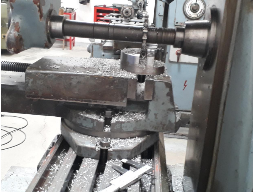
Εικόνα 17. Κατεργασία αυλακιού σε φρέζα
