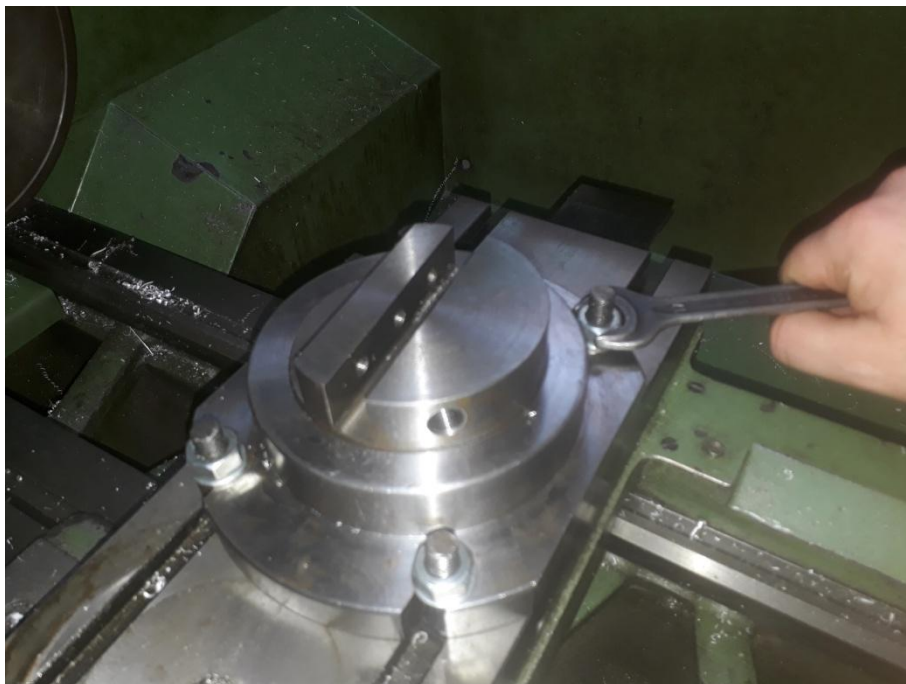
Εικόνα 30. Σύσφιξη περικοχλίων M10
