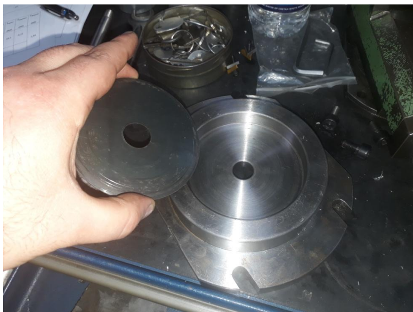
Εικόνα 27. Τοποθέτηση ροδέλας \varnothing 90 στην σταθερή βάση
