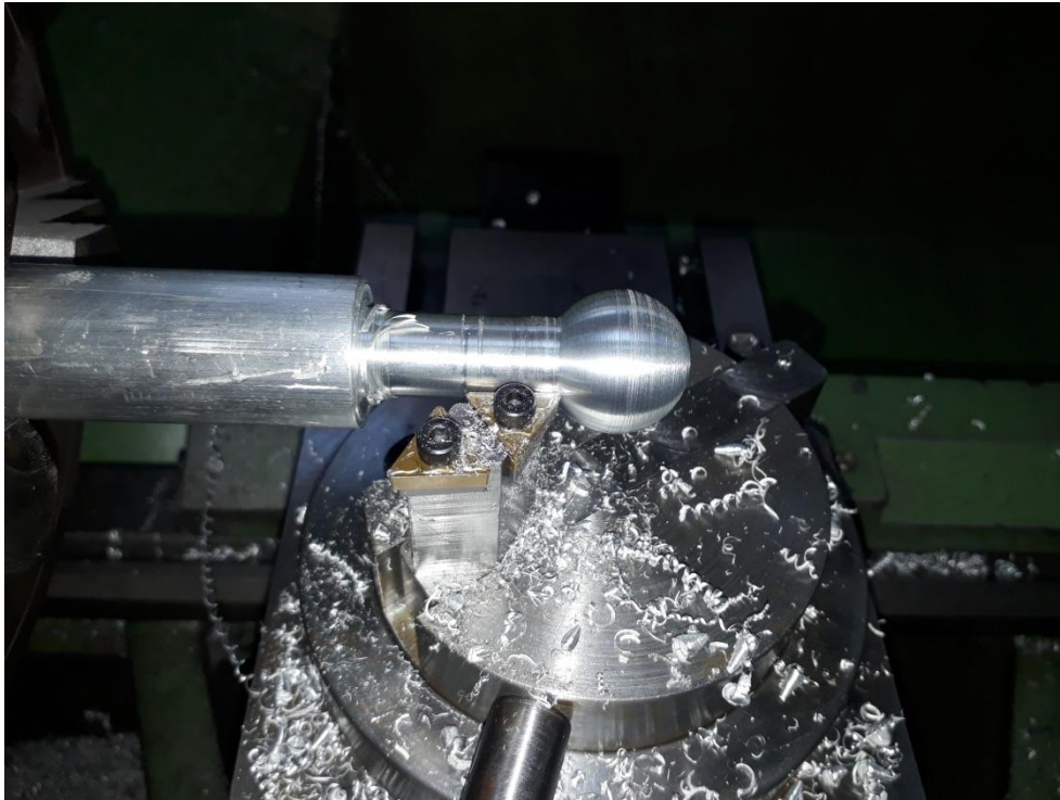
Εικόνα 37. Τελική διαμόρφωση σφαίρας
