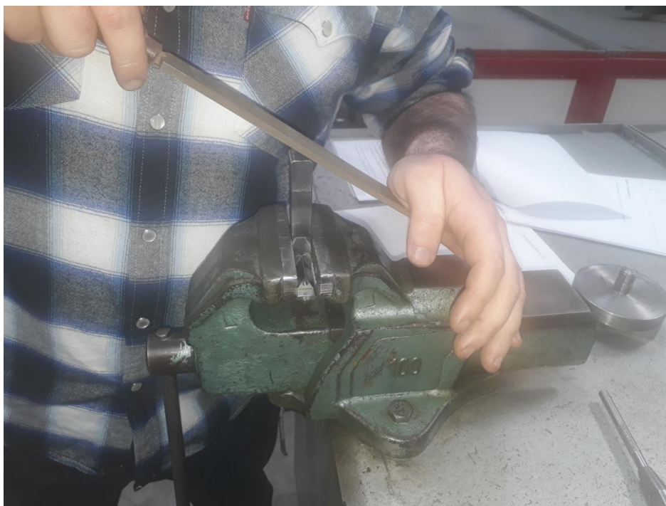
Εικόνα 23. Κατεργασία ραδίου R3 με λίμα χειρός
