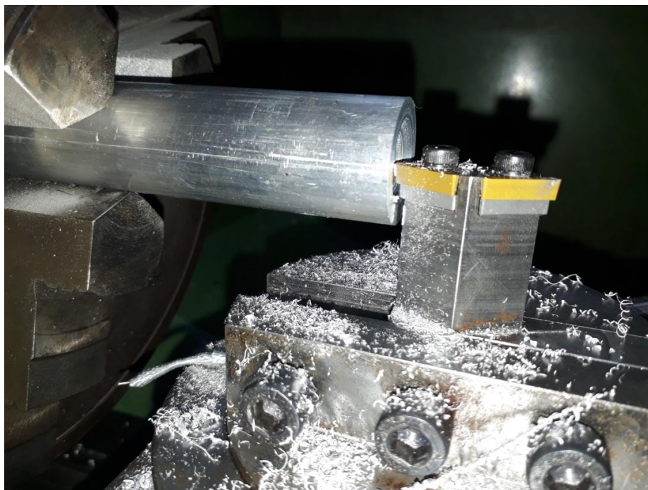
Εικόνα 49. Περιορισμός περαιτέρω κατεργασίας λόγω επαφής μανέλας – τεμαχίου
