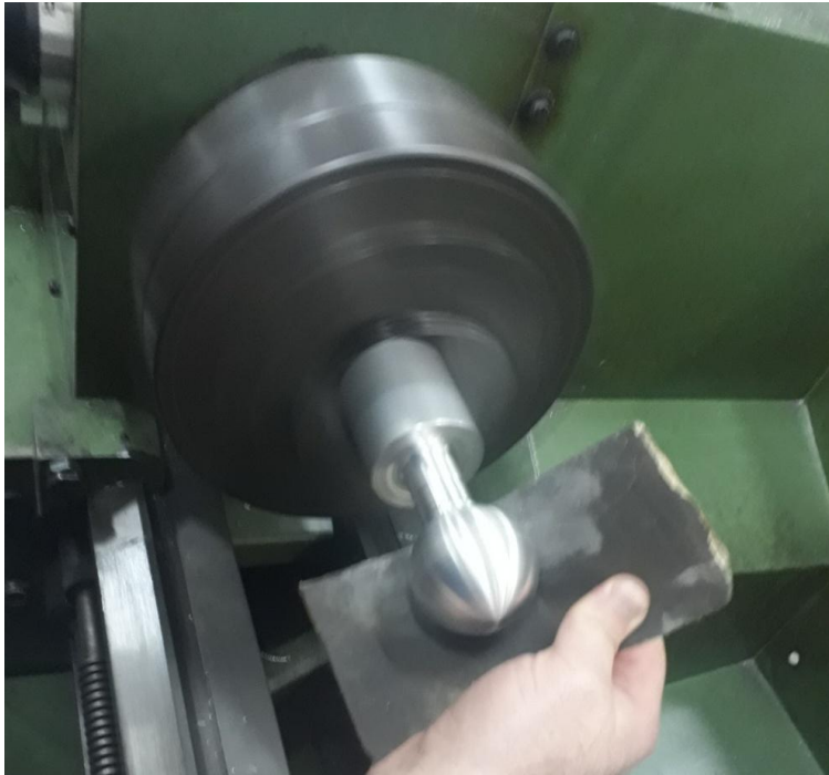
Εικόνα 44. Λείανση σφαίρας με σμυριδόπανο
