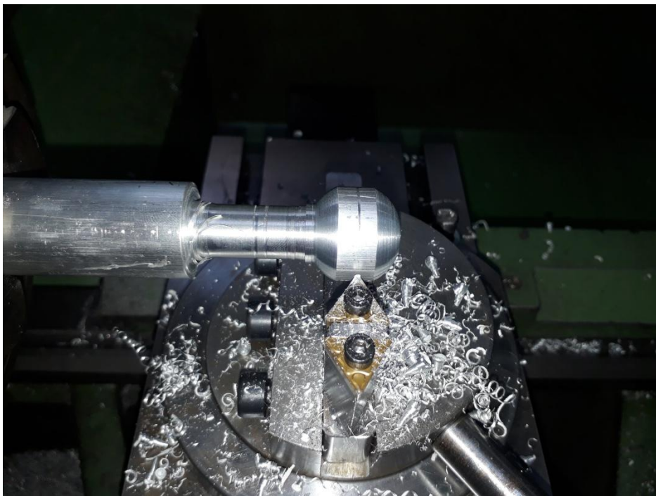
Εικόνα 36. Διαμόρφωση σφαιρικής επιφάνειας σε προχωρημένο στάδιο
