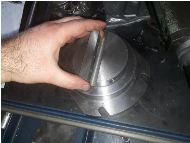
Εικόνα 29. Τοποθέτηση περιστρεφόμενης βάσης
