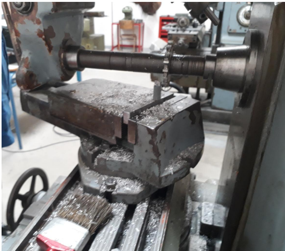
Εικόνα 22. Κατεργασία επιφάνειας σε φρέζα
