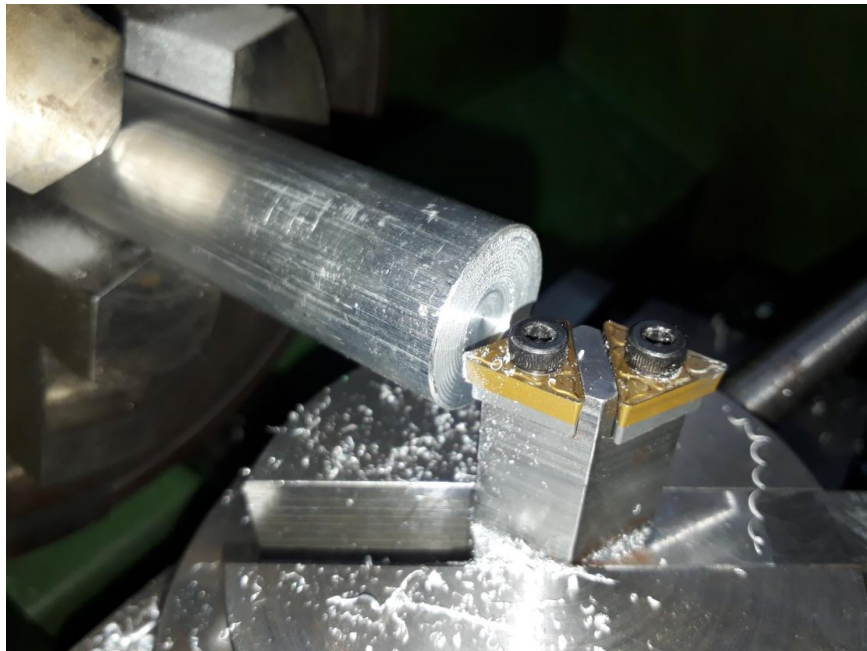
Εικόνα 47. Διαμόρφωση εσωτερικής κοιλότητας σε αρχικό στάδιο
