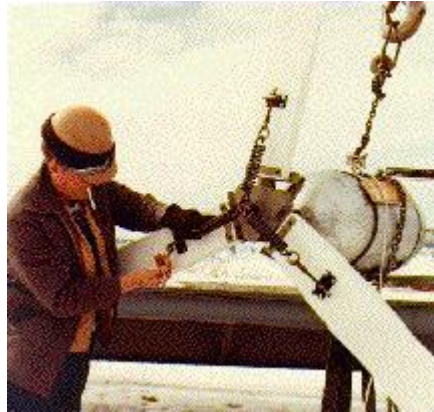
Σχήμα 1.9. M.L. Jacobs ρυθμίζοντας τον μηχανισμό αλλαγής κλίσης που ενεργοποιείται με ελατήριο σε ένα JacobsWind-electric το 1977.
