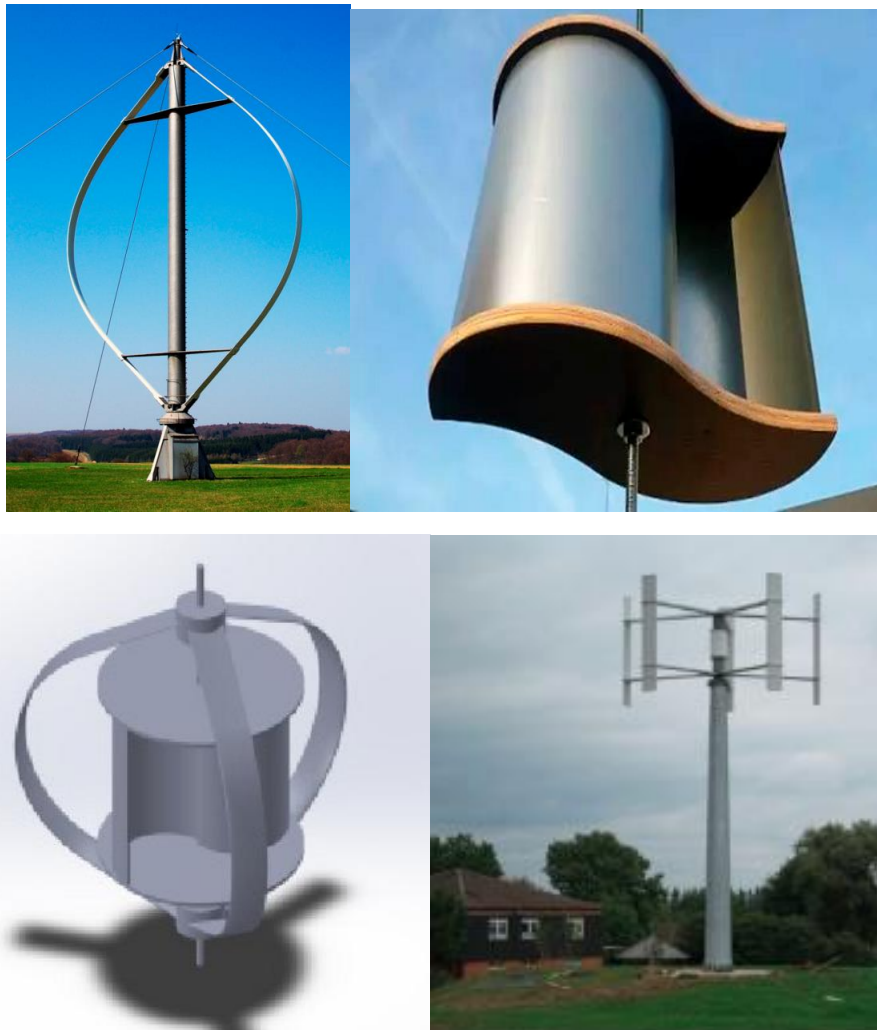
Σχήμα 1.15. πάνω αριστερά: Ανεμοκινητήρας Darrieus, πάνω δεξιά: Ανεμοκινητήρας Savonius κάτω αριστερά : Hybrid Darrieus-Savonius και κάτω δεξιά: Ανεμοκινητήρας τύπου Η
