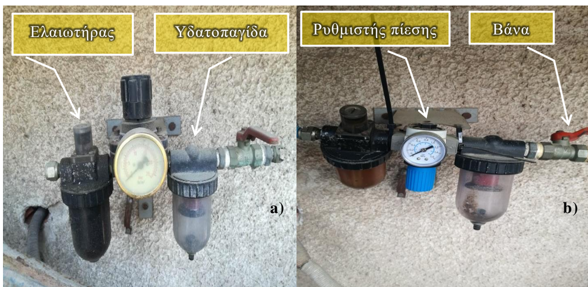
Εικόνα 10: α) Πριν και β) Μετά τον καθαρισμό και την αλλαγή του λιπαντικού και του ρυθμιστή.
