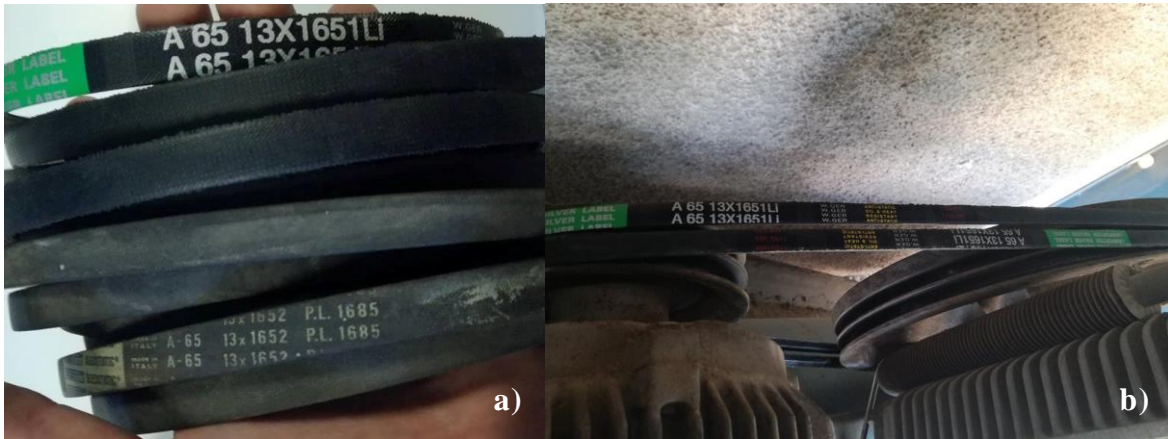
Εικόνα 11: α) Παλαιοί και νέοι ιμάντες, β) Ιμάντες τοποθετημένοι και τανυσμένοι.
