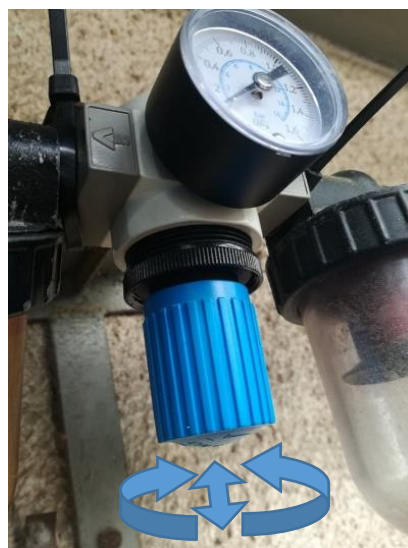
Εικόνα 23: Ρύθμιση της πίεσης εργασίας στον ρυθμιστή πίεσης.
