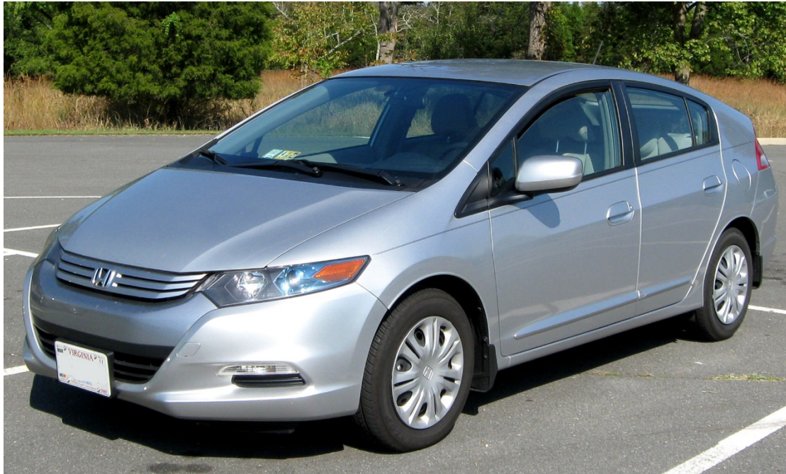
Εικόνα 10: Honda Insight, Mild Parallel Hybrid
